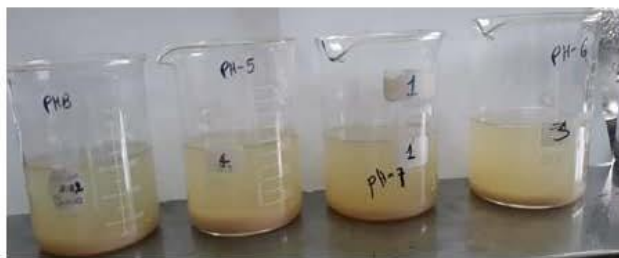
Figura 2. Determinación del pH óptimo en muestras de "Tenería Nuñez" con pH ajustado agregando el volumen óptimo de PAC.
