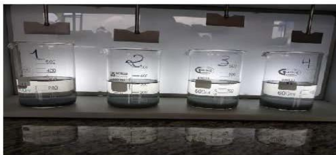
Figura 5. Determinación del pH óptimo en muestras de "Tenería Núñez" con pH ajustado agregando el volumen óptimo de PAC.
