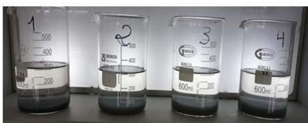
Figura 4. Determinación de volumen óptimo agregando PAC en muestras de "Tenería Núñez".
