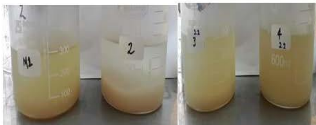
Figura 1. Determinación del volumen óptimo de polímero aniónico catiónico (PAC) en diluciones 1/10 en muestras de "Tenería Nuñez".
