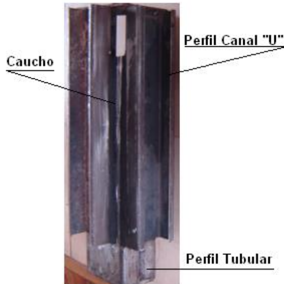
Fig. 1 Sección transversal del amortiguador viscoelástico
