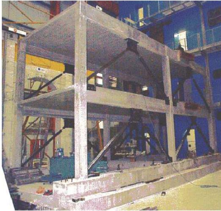
Fig. 4 Vista isométrica de la estructura modelo
