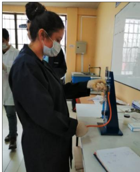
Figura 103. Aprendiendo el uso del aparato de Blaine.
