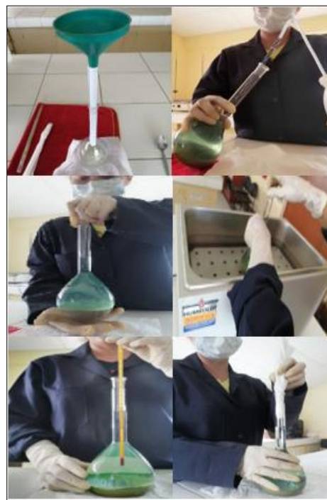
Figura 88. Ensayo de densidad (picnómetro).
