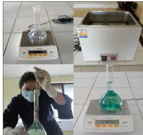
Figura 87. Calibración del picnómetro.
