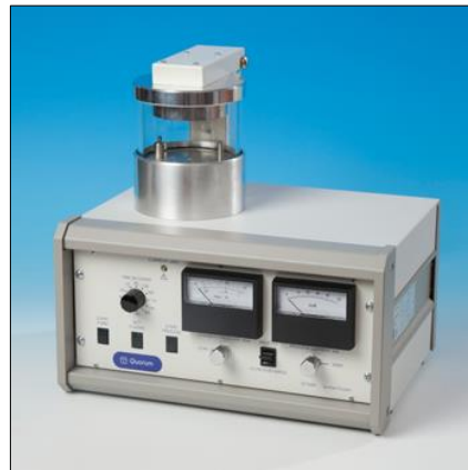
Figura 35. Minisputtering de bajo vacío [70].
