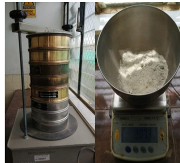
Figura 66. Tamizado y registro de masas para ensayo granulométrico.
