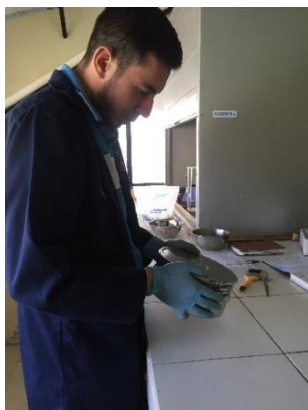
Proceso de movimientos giratorios acompañados de golpes en la parte externa del tamiz
