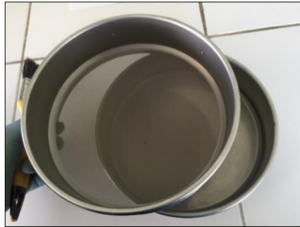
Imagen 36: Equipos para realizar ensayo de finura Fuente: Diego Maldonado
