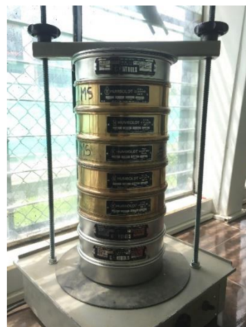
Proceso de tamizado del material resultante de la trituración
