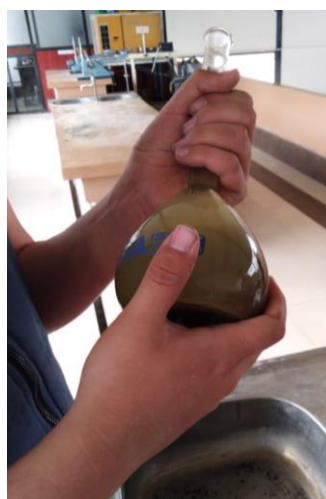
Proceso de movimientos giratorios para sacar burbujas de aire
