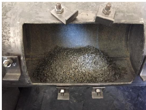
Material depositado en el tambor del molino horizontal
