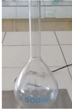
Fig. 16. Picnómetro para sólidos pulverizados
