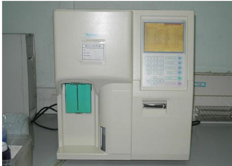
**FOTO N°7.- Analizador de Electrolitos ISE 9180**
