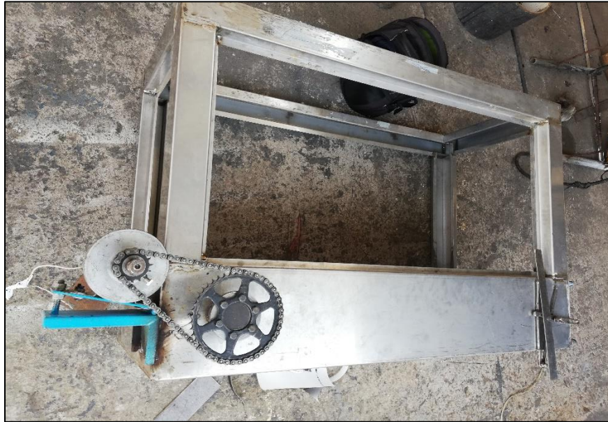
Figura B.3: Colocación motor y conjunto mecánico. Elaborado por: El investigador.
