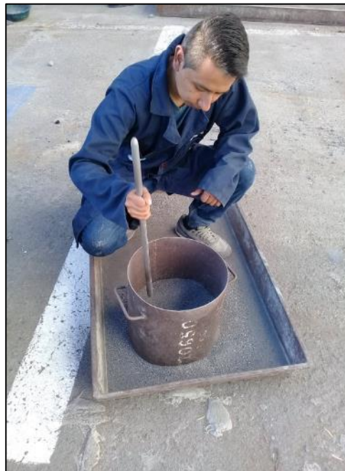
Fotografía 18. Peso volumétrico compactado
