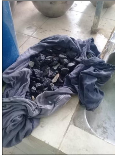
Fotografía 26. Secado de la muestra hasta alcanzar el estado saturado superficie seca (S.S.S)
