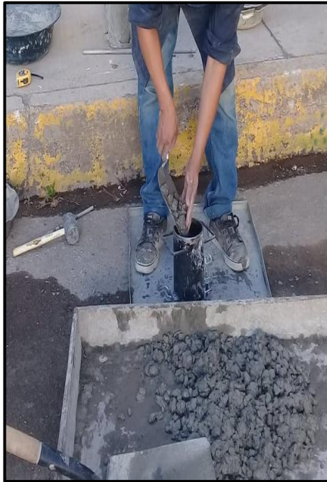
Fotografía 77. Elaboración de cada uno de los especímenes de hormigón
