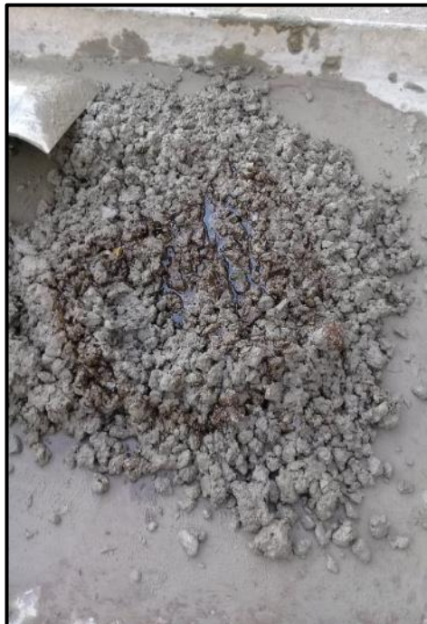
Fotografía 75. Adición de nanosílice en la mezcla
