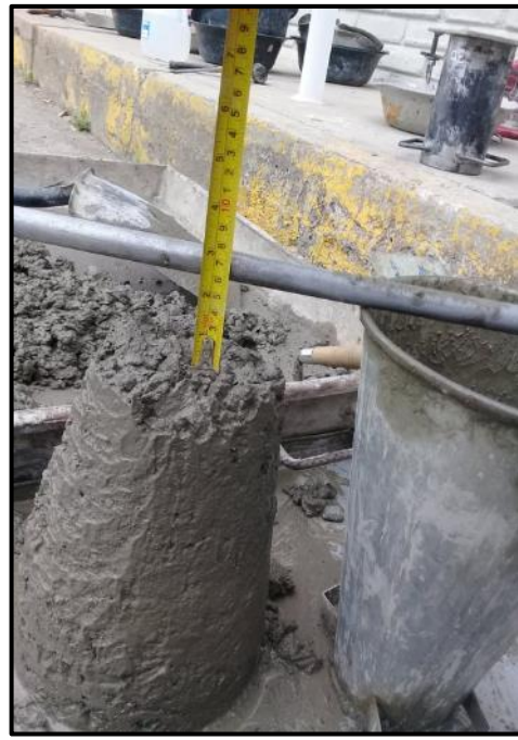
Fotografía 60. Determinación del asentamiento
