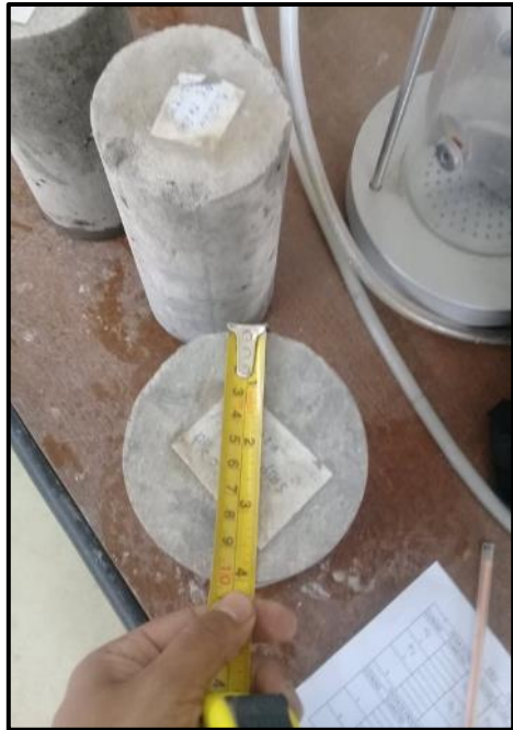
Fotografía 82. Medición del diámetro de los especímenes previo su secado
