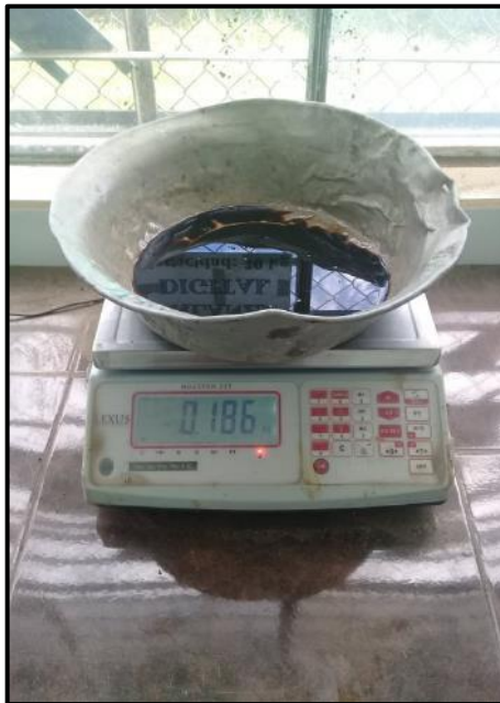
Fotografía 71. Pesaje de la adición de nanosílice
