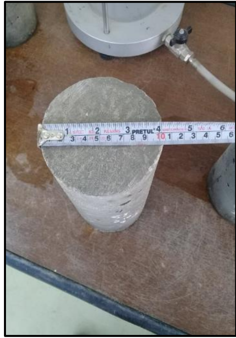
Fotografía 66. Medición del diámetro de los especímenes previo su secado
