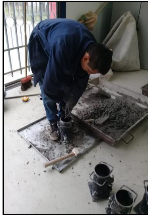
Fotografía 46. Elaboración de cada uno de los especímenes de hormigón
