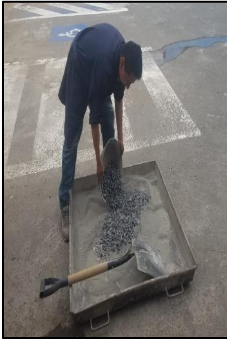
Fotografía 57. Vertido de los agregados
