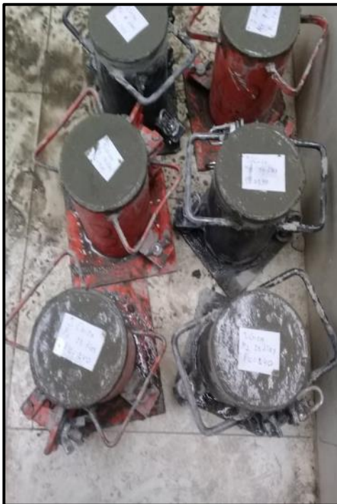
Fotografía 47. Finalización de los especímenes de hormigón f'c=240 Kg/cm 2
