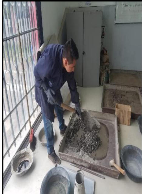
Fotografía 44. Mezclado de los materiales
