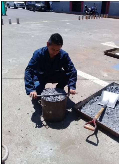
Fotografía 15. Peso volumétrico compactado
