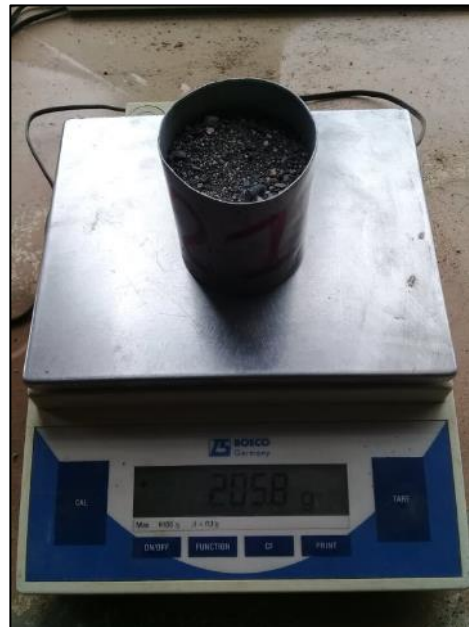
Fotografía 32. Pesaje de la muestra en S.S.S para determinar su capacidad de absorción
