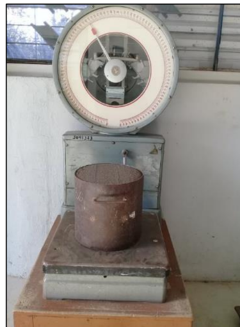
Fotografía 20. Peso del agregado fino en condición suelta
