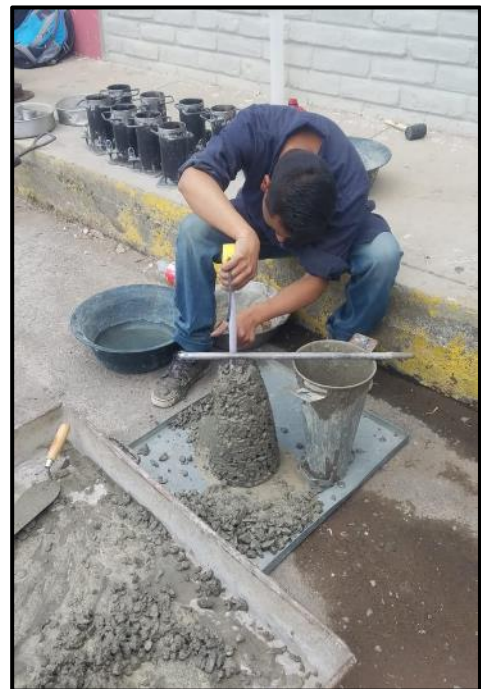
Fotografía 76. Determinación del asentamiento
