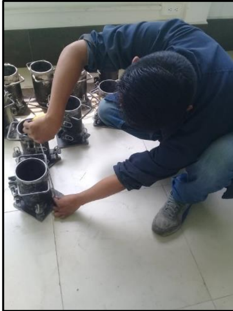
Fotografía 69. Toma de las medidas de los cilindros para el ensaye
