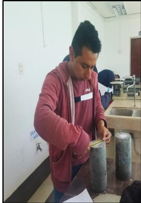
Fotografía 50. Medición de la altura y diámetro de los especímenes a ensayar
