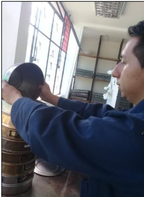
Fotografía 11. Vertido del material por los tamices
