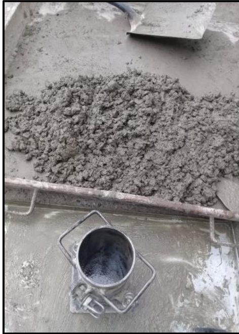
Fotografía 61. Elaboración de los especímenes de hormigón con adición de silicato de sodio
