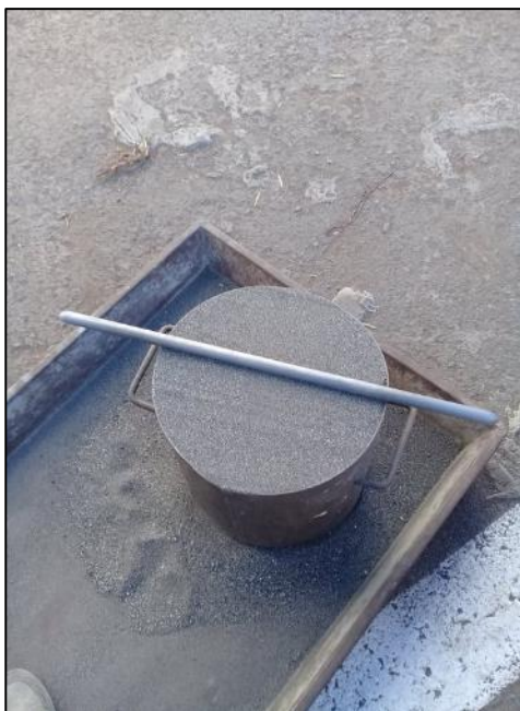
Fotografía 19. Enrasado del agregado fino condición compactada
