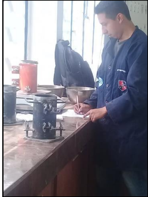
Fotografía 70. Pesaje de los moldes cilíndricos vacíos
