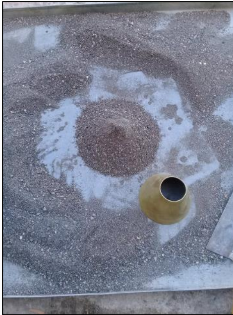
Fotografía 29. Preparación de la muestra hasta alcanzar el estado S.S.S
