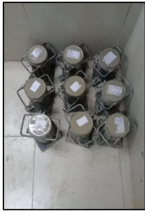
Fotografía 78. Finalización de los especímenes de hormigón con adición de nanosílice
