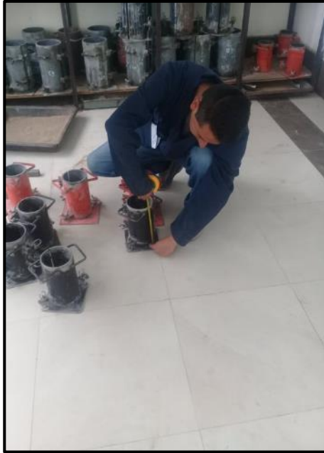
Fotografía 41. Medición de las dimensiones de los moldes cilíndricos
