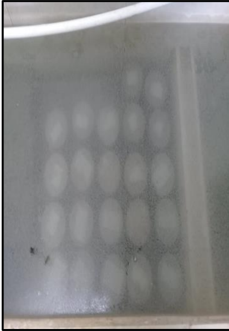
Fotografía 81. Curado de los especímenes
