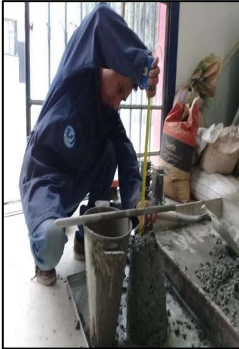
Fotografía 45. Determinación del asentamiento
