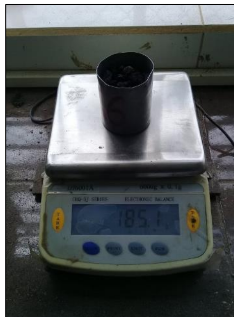
Fotografía 26. Secado de la muestra hasta alcanzar el estado saturado superficie seca (S.S.S)
