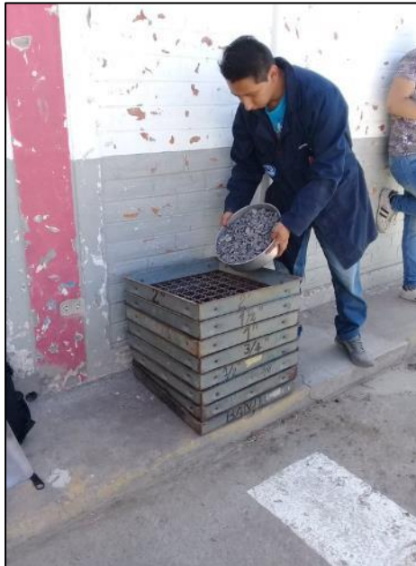
Fotografía 7. Vertido del material por los tamices
