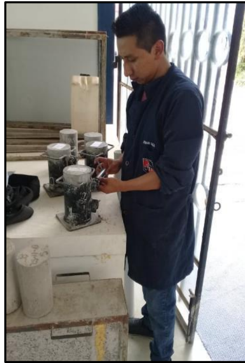
Fotografía 48. Desmolde de cada uno de los especímenes de hormigón
