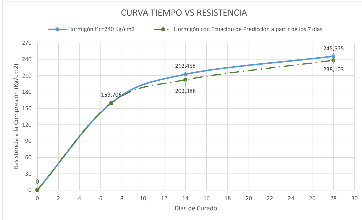
Gráfico 7. Comparación de la resistencia a la compresión del hormigón patrón y la ecuación de predicción
