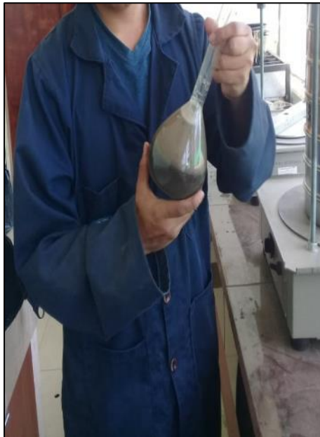
Fotografía 31. Eliminando los vacíos de la muestra en S.S.S más agua
