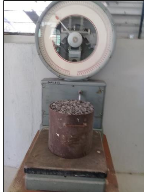
Fotografía 16. Peso del agregado grueso en condición suelta
