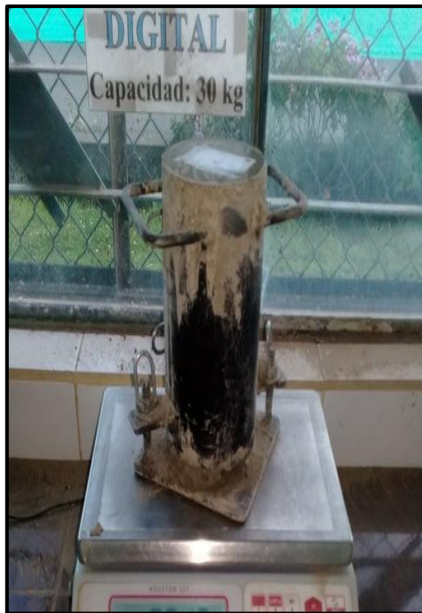
Fotografía 79. Pesaje de cada uno de los moldes llenos de hormigón con adición de nanosílice
