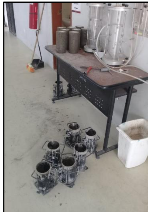
Fotografía 80. Desmolde de los especímenes antes de curarlos
