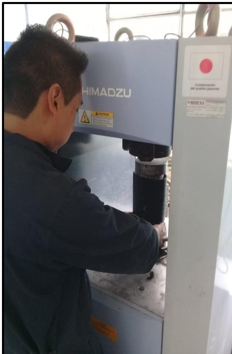
Fotografía 51. Colocación de la probeta de hormigón en la máquina de compresión
