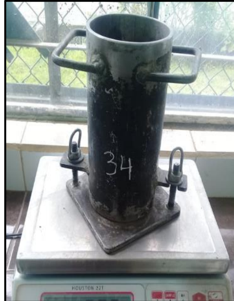
Fotografía 54. Pesaje de los moldes cilíndricos vacíos
