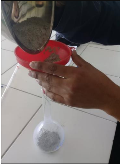
Fotografía 37. Colocación de la muestra de cemento en el picnómetro
