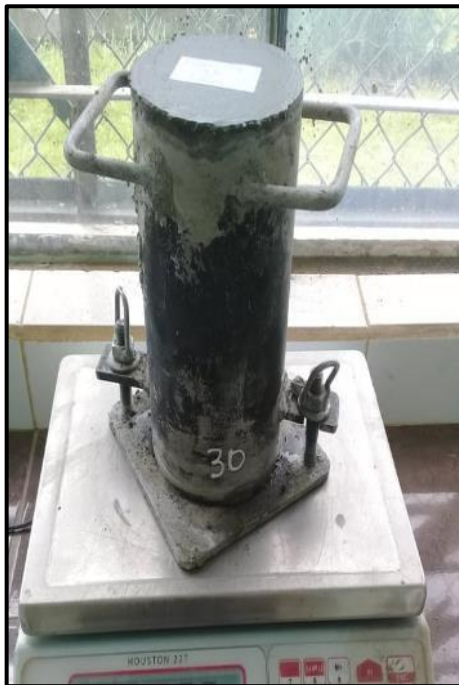
Fotografía 63. Pesaje de los moldes llenos de hormigón en estado fresco
