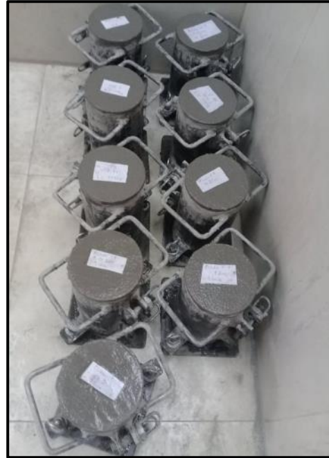
Fotografía 62. Finalización de los especímenes de hormigón
