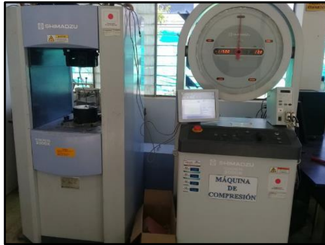
Imagen 10. Máquina para ensayo a compresión del hormigón
