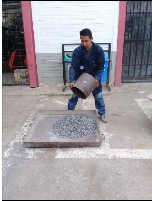
Fotografía 21. Porcentaje de mezcla 100% agregado grueso
