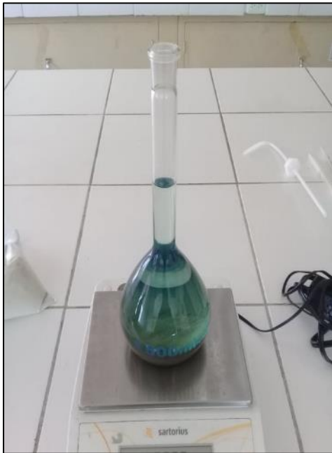
Fotografía 37. Colocación de la muestra de cemento en el picnómetro
