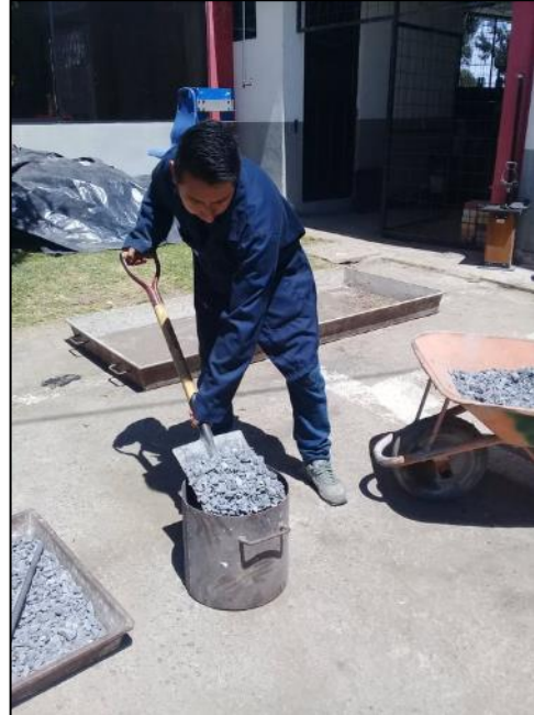
Fotografía 14. Peso volumétrico suelto
