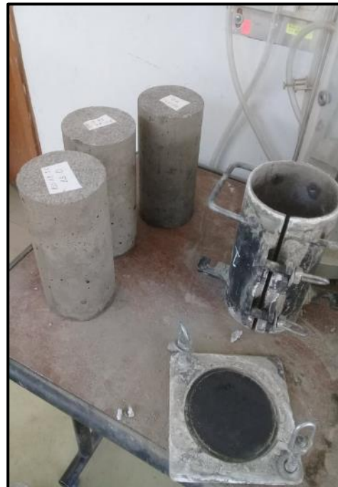
Fotografía 64. Desmolde de los especímenes antes de curarlos
