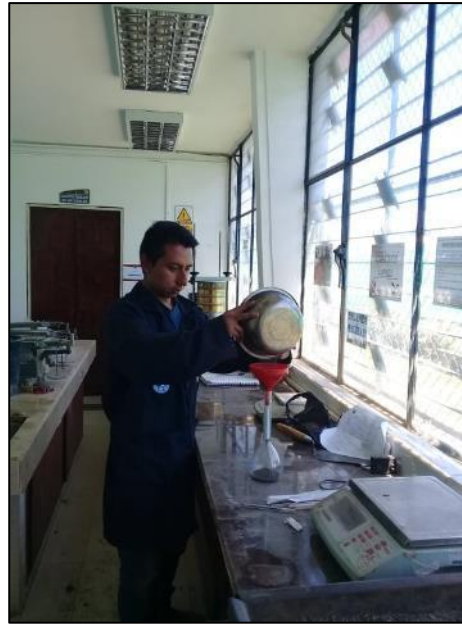
Fotografía 30. Colocación de la muestra (S.S.S) en el picnómetro
