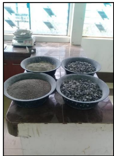
Fotografía 56. Dosificación al peso de cada uno de los materiales
