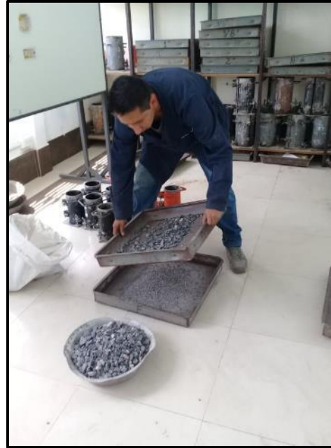
Fotografía 42. Tamizado de los agregados
