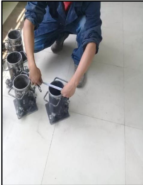
Fotografía 53. Medición del diámetro interior de los cilindros
