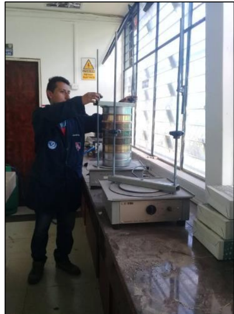
Fotografía 12. Ensayo de granulometría del agregado fino en la tamizadora
