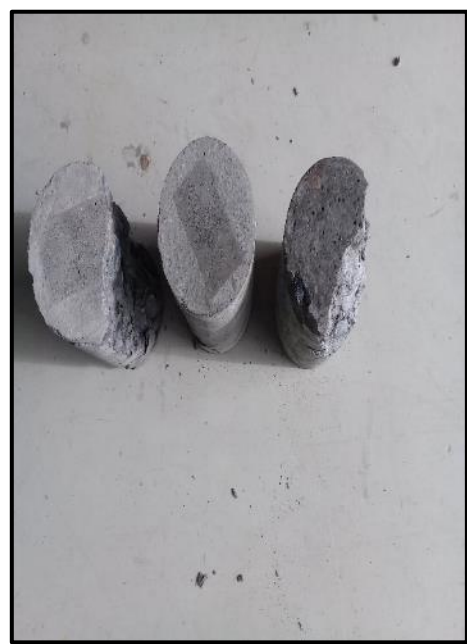
Fotografía 68. Especímenes de hormigón después del ensaye
