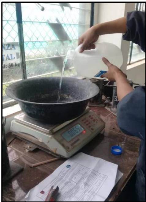
Fotografía 55. Pesaje de la adición de silicato de sodio
