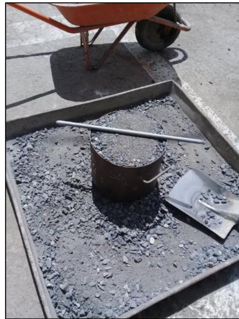
Fotografía 24. Enrasado de la mezcla compactada de los agregados antes de su pesaje
