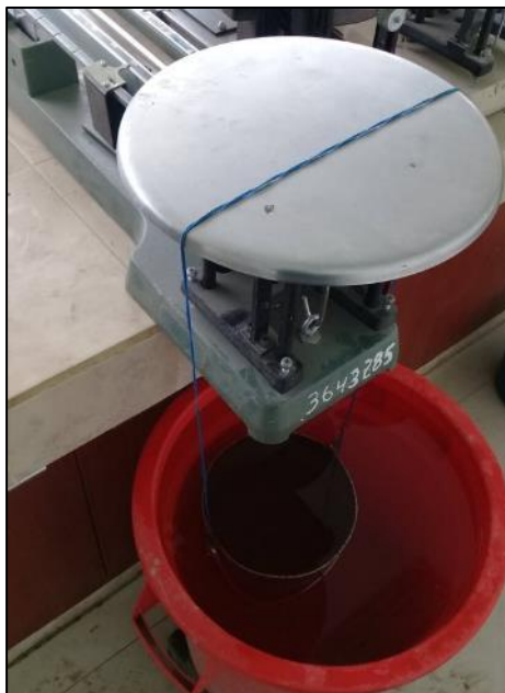
Fotografía 27. Peso de la muestra en S.S.S más la canastilla
