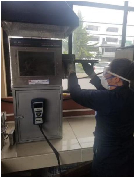
Gráfico 11 Ingreso de probeta a Cabina
