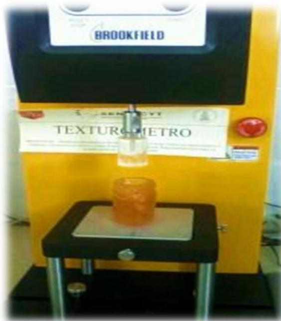
**Fotografía J-6:** Determinación de textura de mermelada de zanahoria amarilla (*Daucus carota*) mediante una mezcla con manzana a diferentes concentraciones de pectina.
