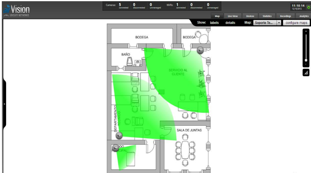
Figura 10. Ubicación cámara Soporte técnico y Nodo Principal Elaborado por: El investigador
