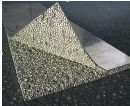
Figura 1. 8 Material compuesto tipo Sándwich de Aluminio [15].
