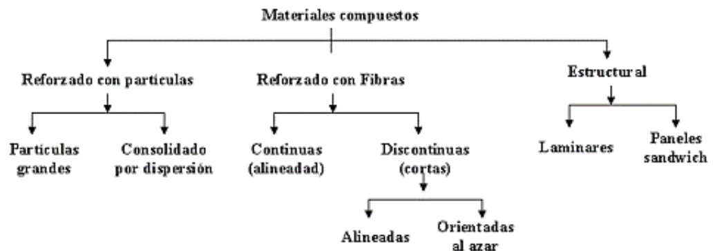
Figura 1. 9 Clasificación de materiales compuestos por su refuerzo
