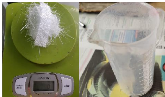
Figura 2. 2 Gravimetría para densidad de fibra de vidrio
