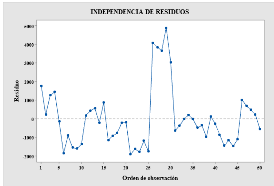
Figura 3. 11 Orden de observación vs Residuos del módulo de elasticidad a flexión Fuente: [24]
