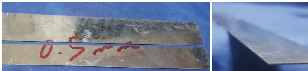
Figura 1.98 Corte 0.5 mm de espesor acero galvanizado
