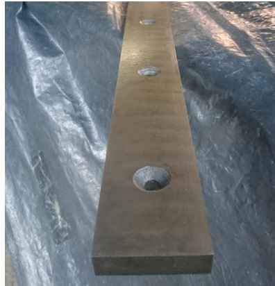
Figura 1.87 Cuchilla terminada en acero K100
