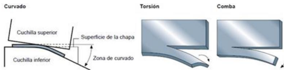
Figura 1.6 Borde producido por el cizallado; [9].
