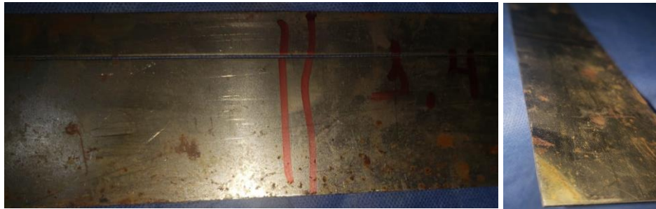
Figura 1.95 Corte 1.4mm de espesor acero galvanizado
