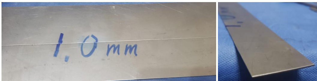
Figura 1.96 Corte 1.0 mm de espesor acero inoxidable
