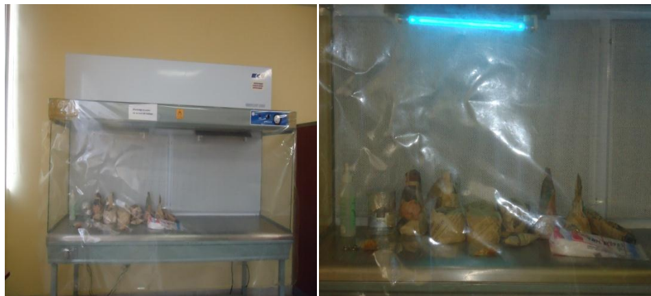
CÁMARA DE FLUJO LAMINAR
