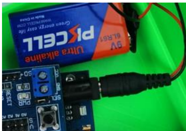
Figura 20: Conexión entre la batería y la Placa Arduino Elaborado por: Bryan Punina, 2019
