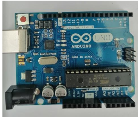
Figura 16: Placa Arduino Uno Elaborado por: Bryan Punina, 2019
