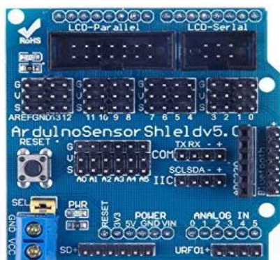
Figura 17: Placa Shield Elaborado por: Bryan Punina, 2019
