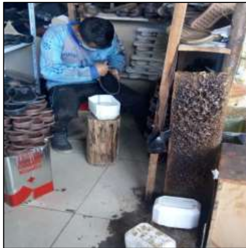
Figura 27. Aplicación de reactivador
