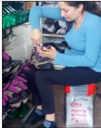
Figura 32. Proceso de terminado, colocación de plantillas, cordones y etiquetas
