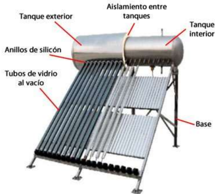
Figura 25. Componentes de calentador solar. [44]
