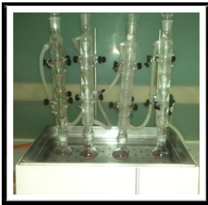
Dispositivo para la hidrólisis de los elagitaninos
