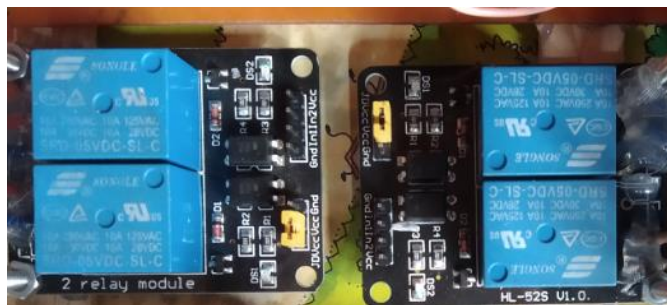
Figura N°36: Elementos que componen el Circuito Control.
