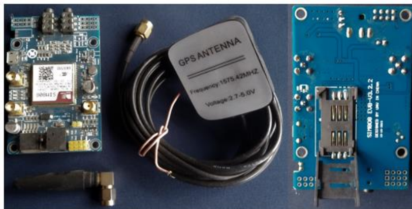
Figura N°27: Partes de la SIM 808.
