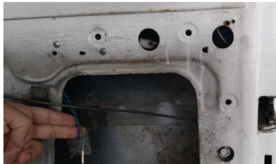
Figura N°62: Instalación de los motores en las Puertas del Vehículo.
