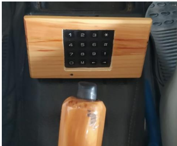
Figura N°60: Instalación del Teclado Matricial.
