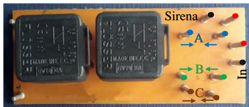
Figura N°25: Implementación Circuito Cortacorriente del Vehículo.
