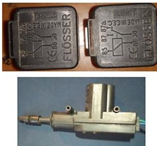
Figura N°23: Motor 12V para seguro de puertas y relés actuadores 12V.
