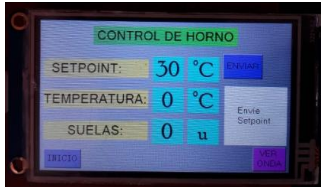
Fig.3. 42:Pantalla HMI implementada en el horno eléctrico Elaborado por: Investigador
