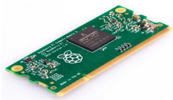
Fig.3. 22: Tarjeta de desarrollo raspberry pi CM3. [35]
