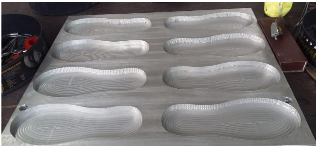
Figura 4. 17. Desmontaje de la placa segunda etapa.
