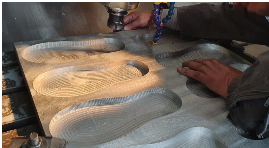
Figura 4. 16. Mecanizado de contrasalidas segunda etapa.
