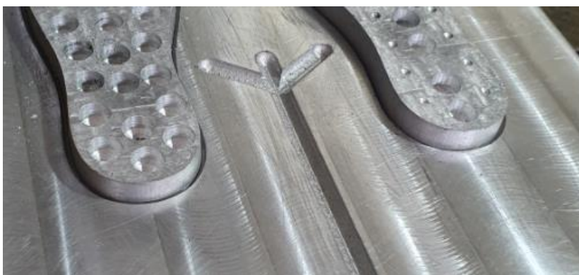
Mecanizado de canales de inyección.
