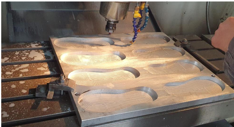
Figura 4. 14. Mecanizado cavidades base primera etapa.
