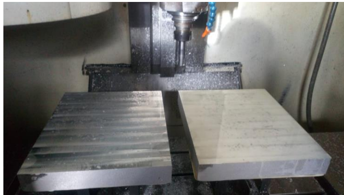
Figura 4. 11. Ubicación y sujeción de bloques.
