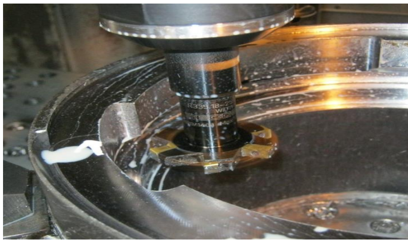
Figura 2. 12. Mecanizado de contrasalidas.
