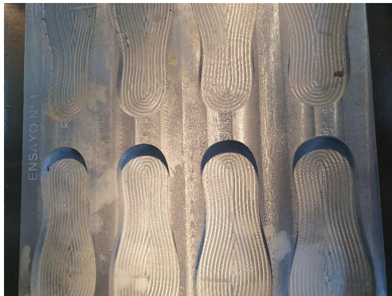
Figura 4. 21. Medición de resultados en cavidades.
