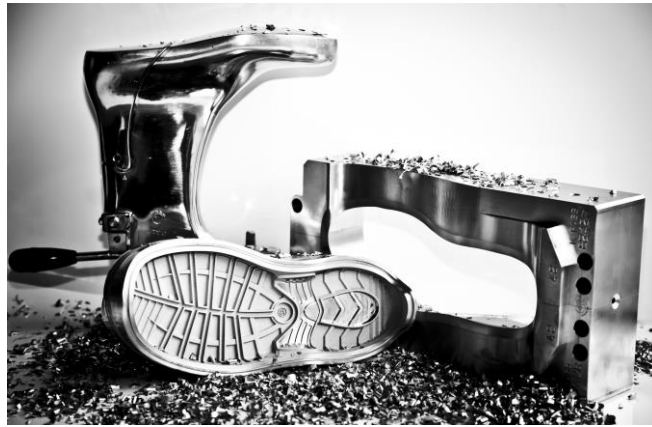
Figura 2. 24. Molde de suela mecanizado en CNC.
