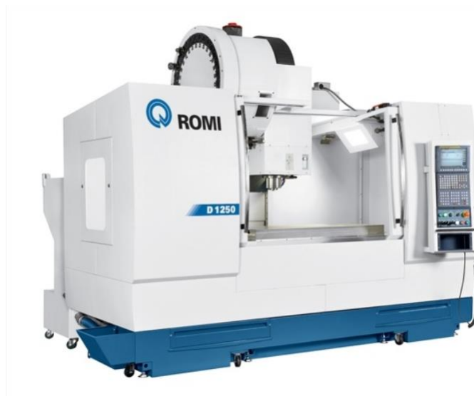
Figura 2. 9. Centro de mecanizado de tres ejes.
