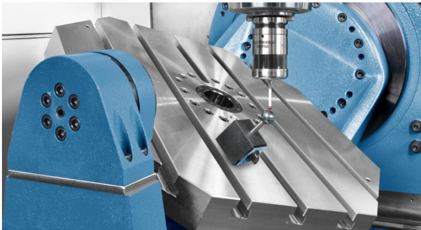
Figura 2. 11. Centro de mecanizado de cinco ejes.
