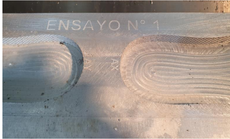
Figura 4. 24. Mecanizado CNC de placa de ensayo N°. 1.
