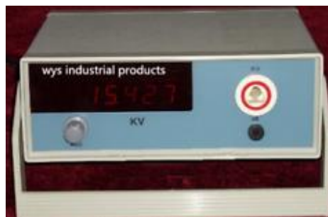
Figura 40. Fuente de alimentación de alto voltaje para electrospinning. [22]
