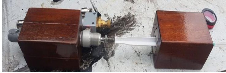
Figura 79. Inyector de la sustancia polimérica. Fuente: [Autor]
