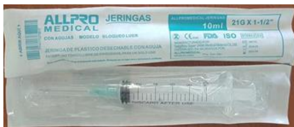
Figura 22. Jeringa de 10 mililitros (ml) utilizada para el proceso de electrohilado. [21]
