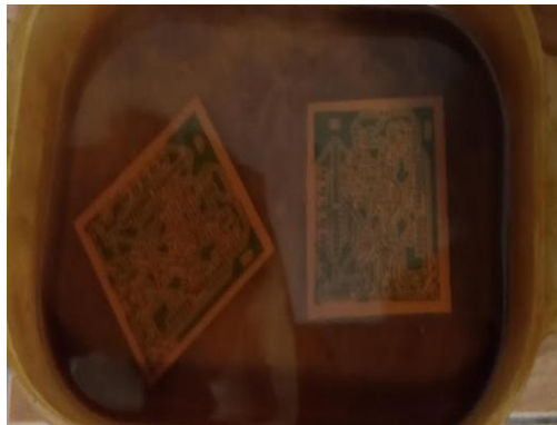
Figura 28. Ataque químico con ácido. Fuente: [Autor]
