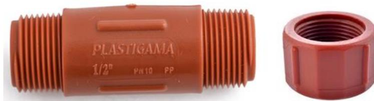
**Figura 2. 8.** Neoplo PVC para realizar las probetas a compresión
