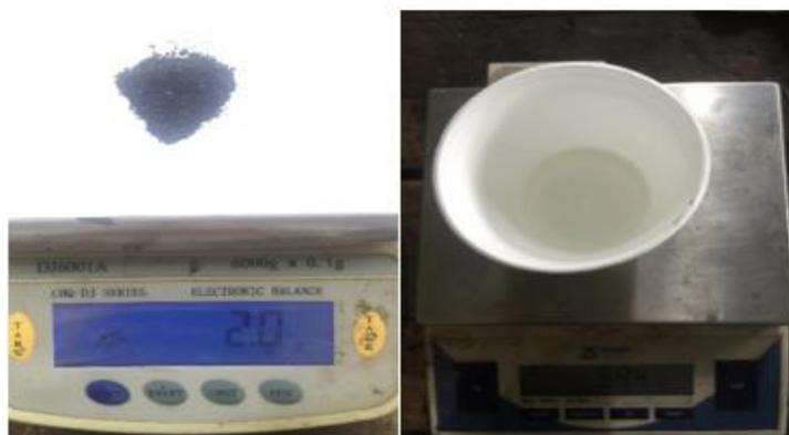
**Figura 2. 10.** Pesaje del Caucho Reciclado y del Poliuretano
