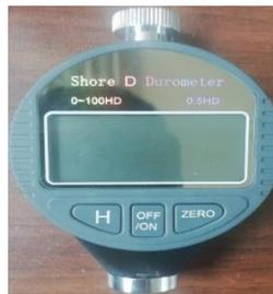
**Figura 2. 28.** Máquina para ensayo de dureza Shore D
