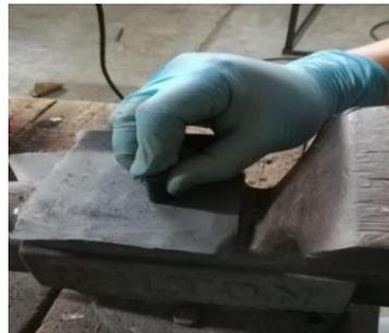
**Figura 2. 23.** Lijado de la probeta
