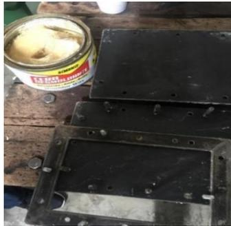
**Figura 2. 12.** Aplicar cera desmoldante en el molde
