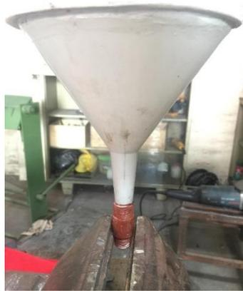
**Figura 2. 19.** Vertiendo el material en el molde con embudo
