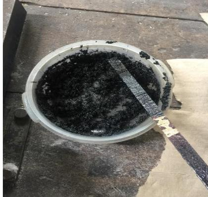
**Figura 2. 11.** Incorporación del Caucho Reciclado y del Poliuretano
