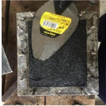
**Figura 2. 13.** Colocación del material en el molde
