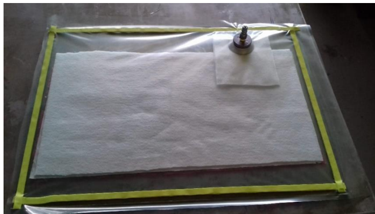
Figura 36.- Colocación del bagging film y la válvula extractora de aire. [Autor]
