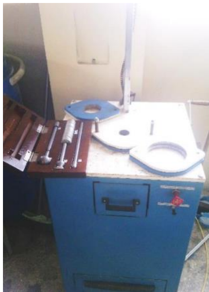
Figura 10.- Máquina de Impacto por caída de dardo. [Laboratorio de Ingeniería Civil y Mecánica. FICM-UTA]
