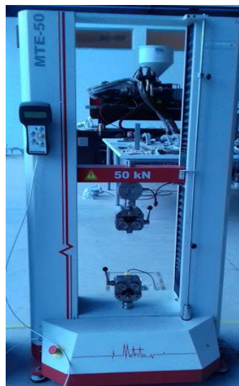
Figura 8.- Metrotec Serie MTE50: Máquina de Ensayos Universales de hasta 50 KN para materiales polímeros, cerámicos, compuestos. [Metrotec]
