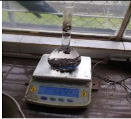
Pesar el picnómetro + agua + agregados reciclados
