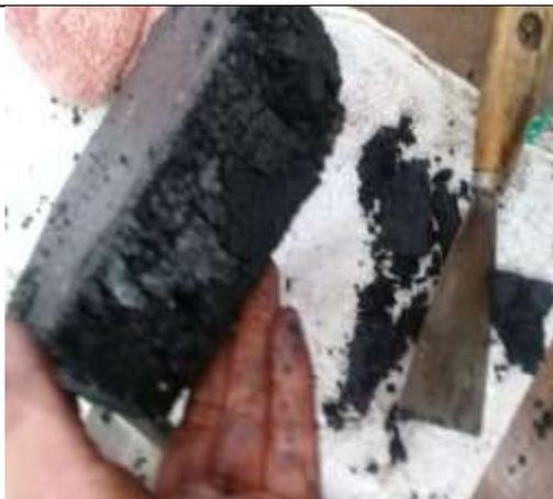
Adoquín ensayado a compresión de 7cm
