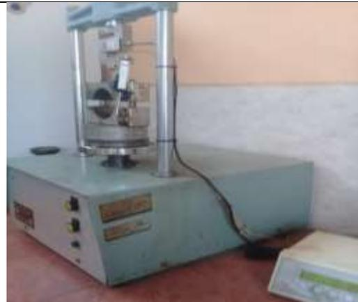
Ensayar la estabilidad y flujo en la máquina de Marshall
