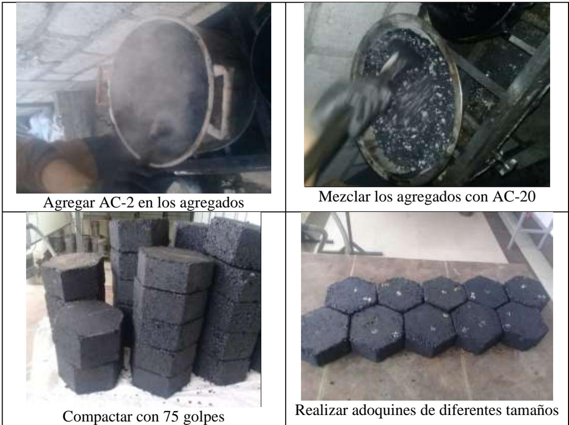
**Fabricación de adoquines de mezclas asfálticas en caliente utilizando agregados no reciclados. MOP – 001 – F – 2002**
