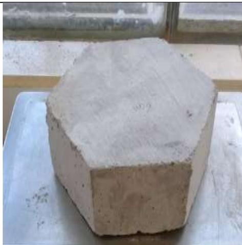
Desmoldar y colocar en agua por 28 días
