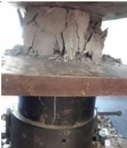
Adoquín ensayado a compresión de 6 cm
