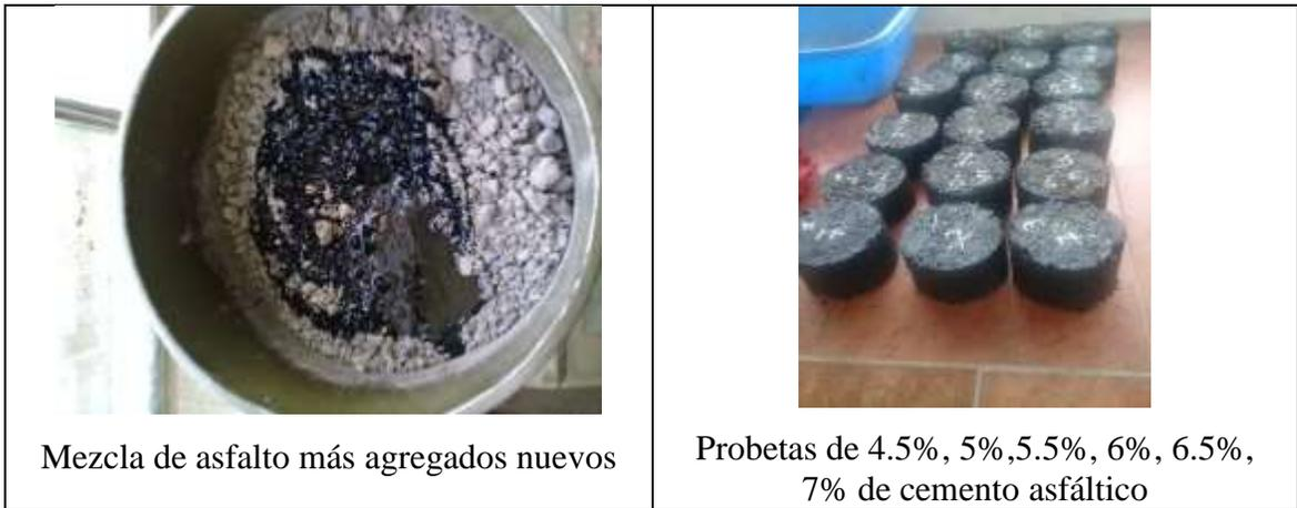
**Ensayo Rice para mezclas asfálticas en caliente utilizando agregados reciclados y no reciclados utilizando diferentes porcentajes de mezcla asfáltica Norma I.N.V.E 735 – 07**
