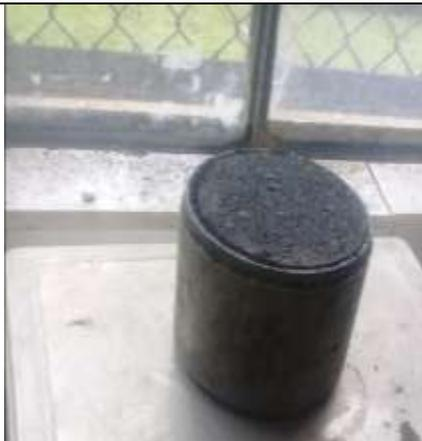
Dejar secar la probeta durante 2 horas
