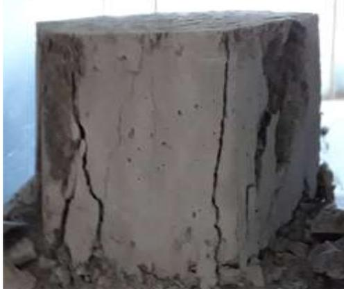
Adoquín ensayado a compresión de 7cm
