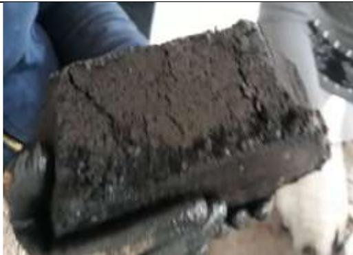
Adoquín ensayado a compresión de 8cm
