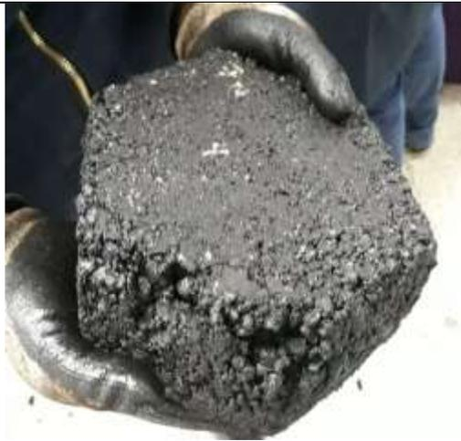
Adoquín ensayado a compresión de 7cm
