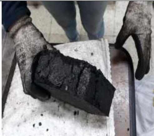
Adoquín ensayado a compresión de 6 cm
