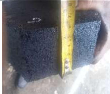
Medir el adoquín para comprobar su altura
