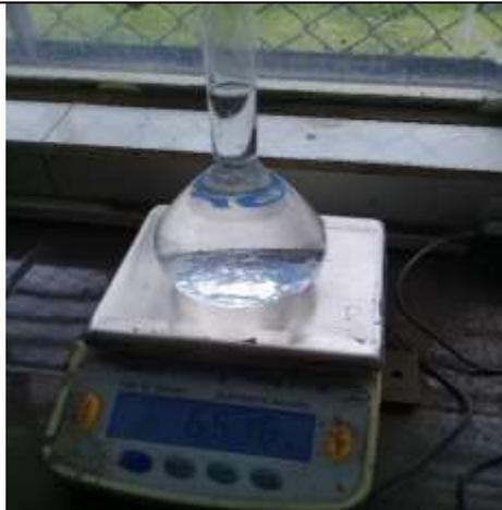
Llenar agua en el picnómetro hasta la marca de aforo y pesar
