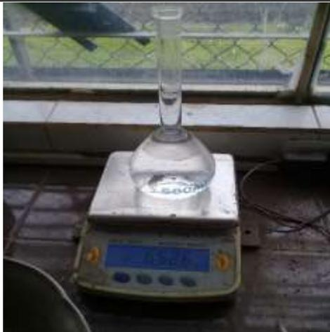
Pesar el picnómetro con agua hasta la marca de aforo
