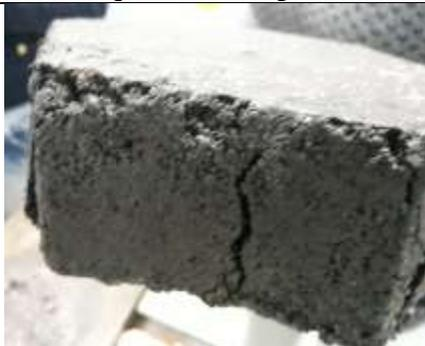
Adoquín ensayado a compresión de 8cm
