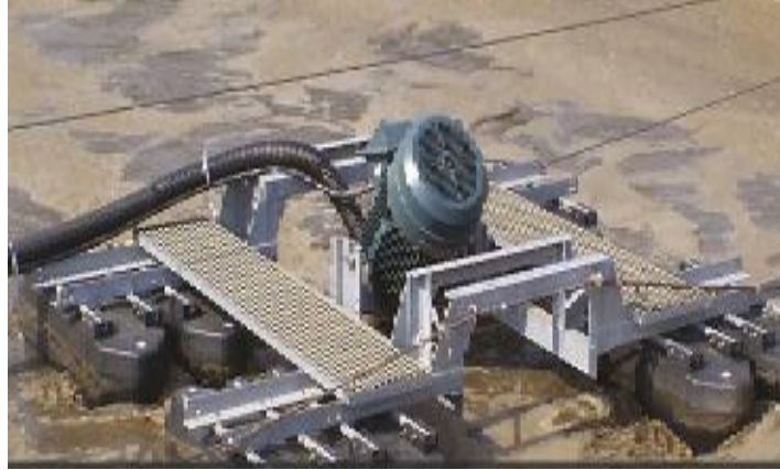
Figura 7. Aireación para aguas industriales
