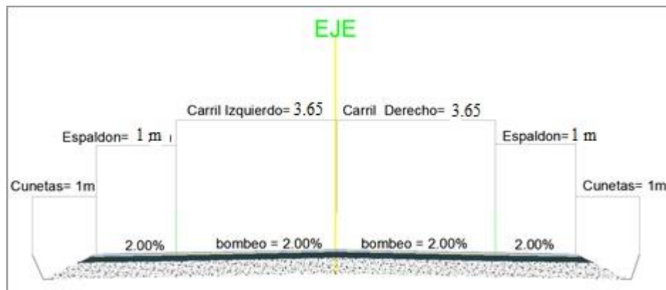
Figura 37. Sección Transversal del Proyecto.
