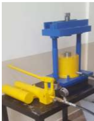
Gráfica 3-14. Prensa hidráulica de compactación de polvo metálico [Autor].
