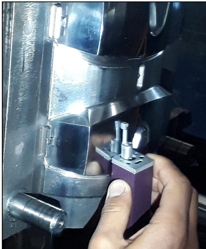
Fotografía 14, medición de rugosidad molde macho gafas. Fuente: Autor.
