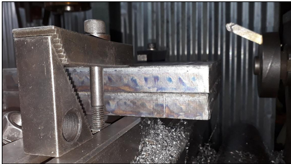
Fotografía 2, rectificado de placas en bruto de dos piezas. Fuente: Autor.
