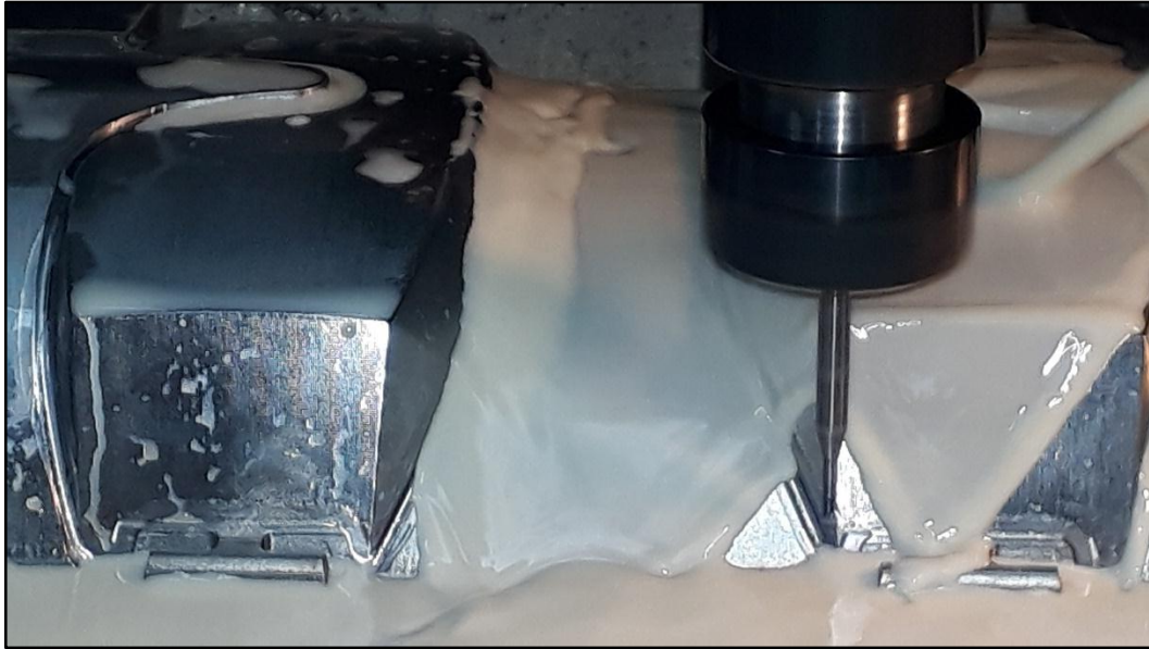
Fotografía 9, acabado molde macho gafas, comparación con impresión 3D. Fuente: Autor.
