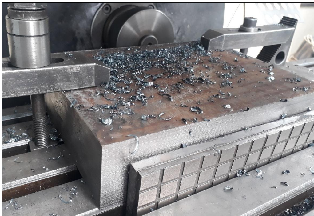
Fotografía 4, rectificado de bloque hembra gafas. Fuente: Autor.
