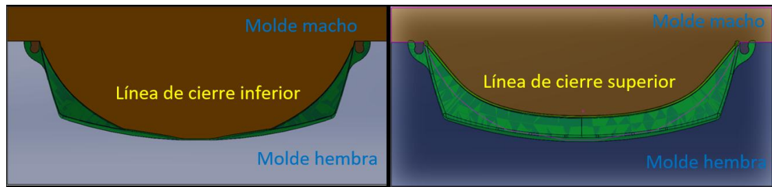
Figura 23. Gafas 3D, cavidad macho y hembra ensambladas, vistas inferior y superior.
