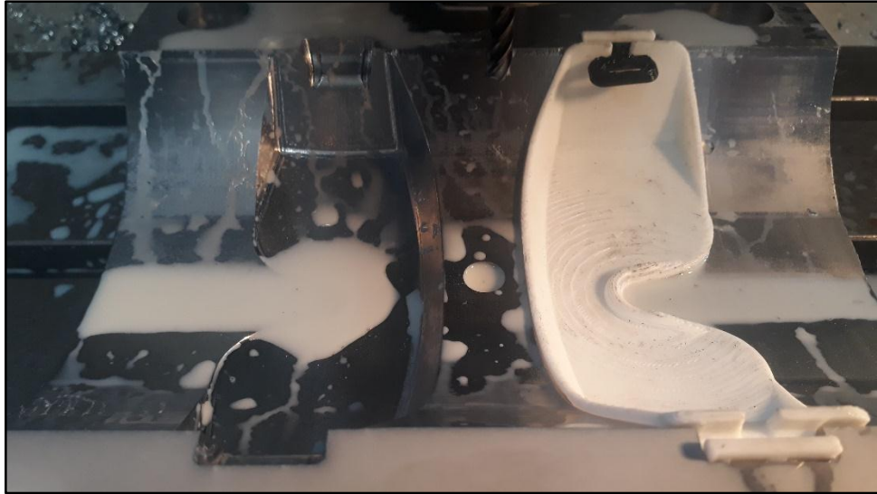
Fotografía 5, acabado y taladrados molde hembra gafas. Fuente: Autor.
