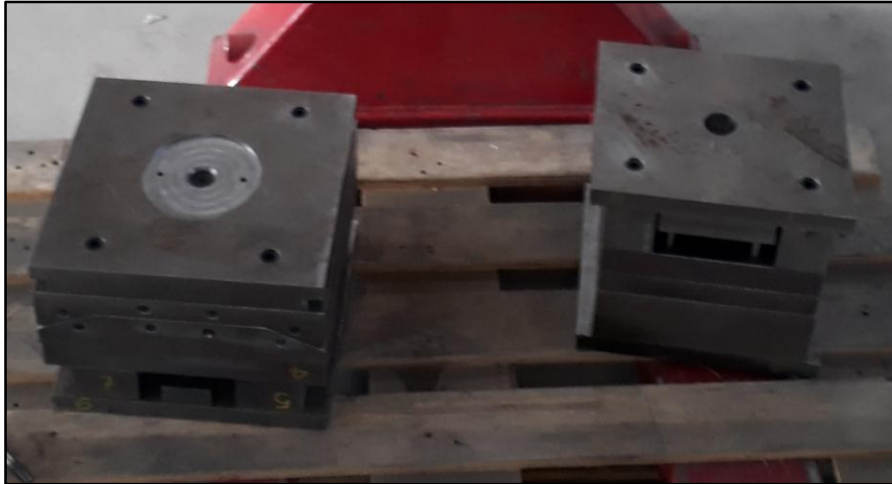
Fotografía 13, moldes ensamblados. Fuente: Autor.
