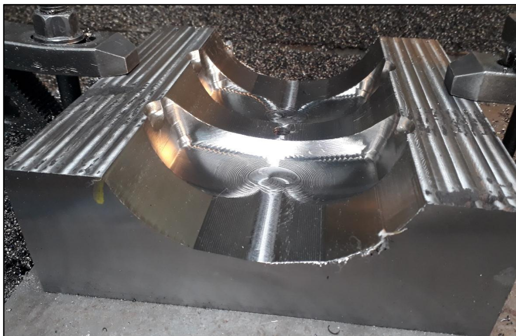
Fotografía 4, rectificado de bloque hembra gafas. Fuente: Autor.
