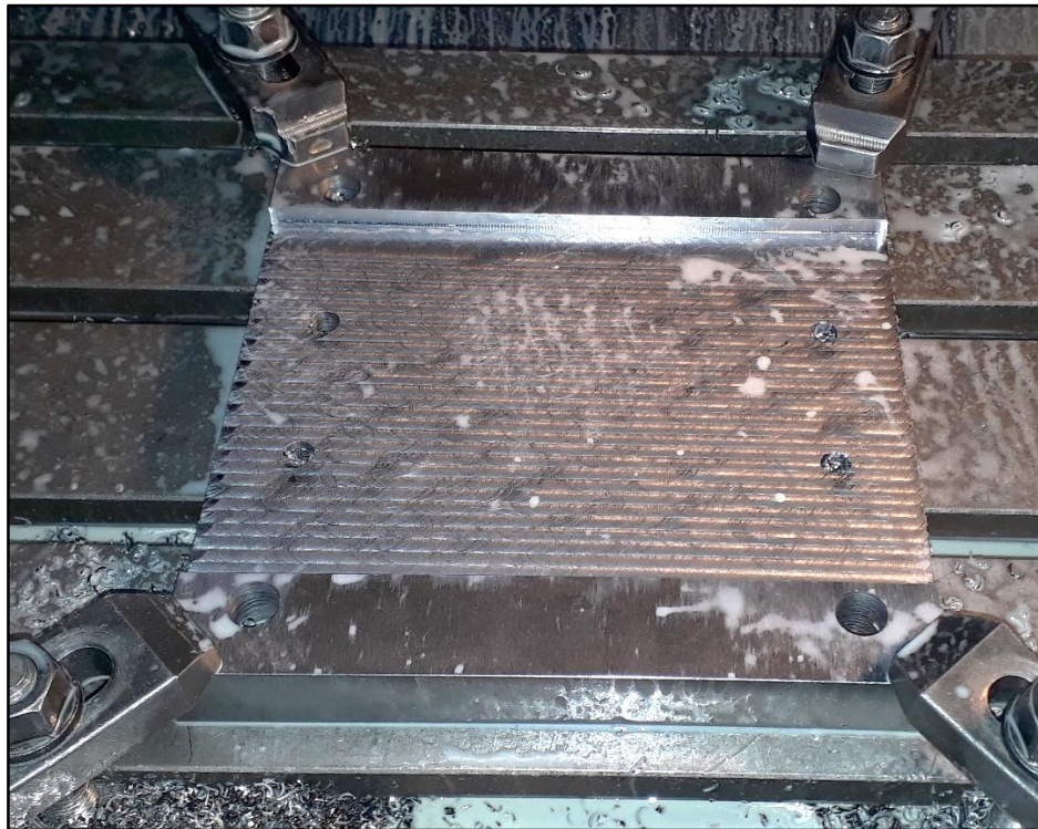
Fotografía 6, desbaste, taladrados molde macho gafas. Fuente: Autor.
