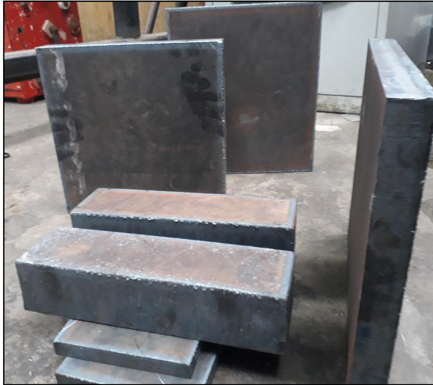
Fotografía 2, rectificado de placas en bruto de dos piezas. Fuente: Autor.
