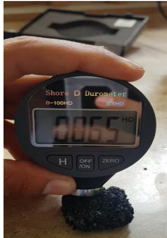
Figura 14. Dispositivo de medición de dureza en probetas.
