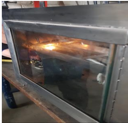
Figura 17. Mechero bunsen aproximando a la probeta.
