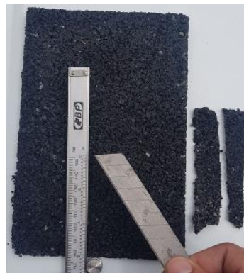
Figura 9. Probetas para ensayos de inflamabilidad
