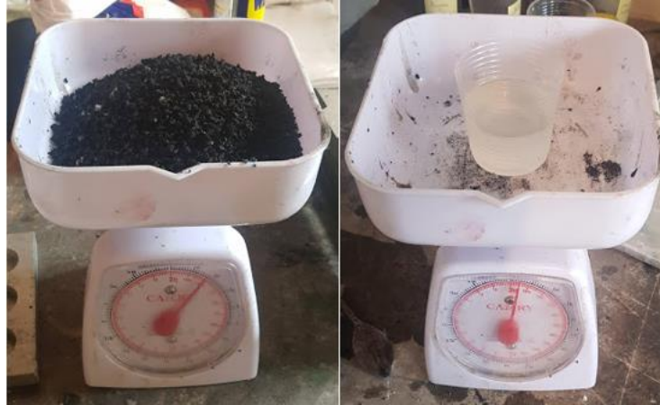
Figura 4. Pesaje de resina y gránulo de caucho
