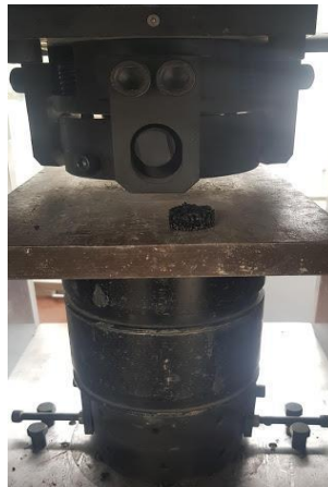
Figura 12. Colocación de probetas y ajuste de mordazas en máquina en compresión.
