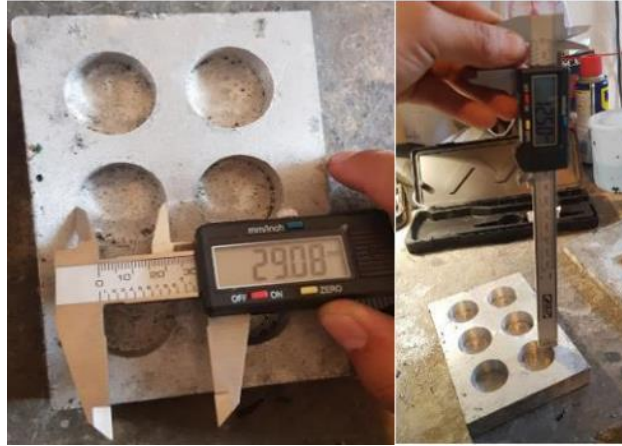
Figura 2. Dimensiones del molde para cálculo de densidad
