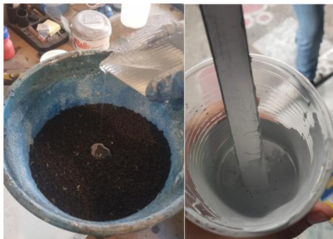
Figura 5. Mezcla de resina y gránulo de caucho
