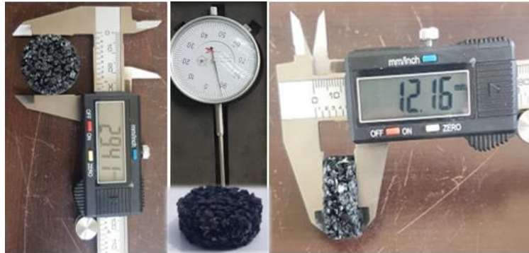
Figura 11. Datos de mediciones de probeta a ensayar compresión.
