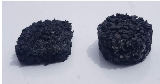
Figura 8. Probetas para ensayos de compresión y dureza
