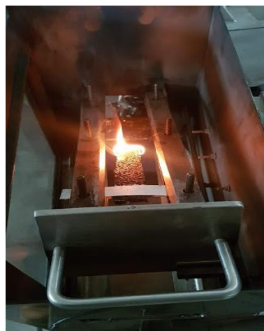
Figura 18. Medición de velocidad de quemado.
