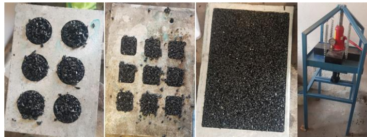
Figura 6. Aplicación del material en los moldes
