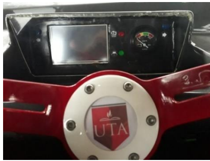
Figura 4.29 Implementación de las Interfaz Graficas en el tablero
