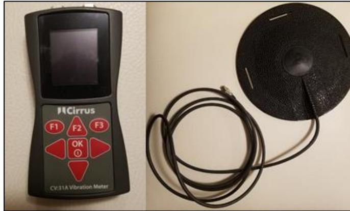
**Fig. 9** Vibrómetro Cirrus Research plc CV:31A.
