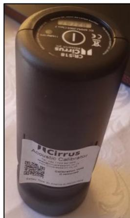
**Fig. 10** Calibrador acústico Cirrus Research plc.
