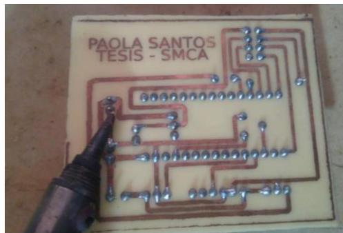
Fig. 4.43: Soldadura de los elementos
