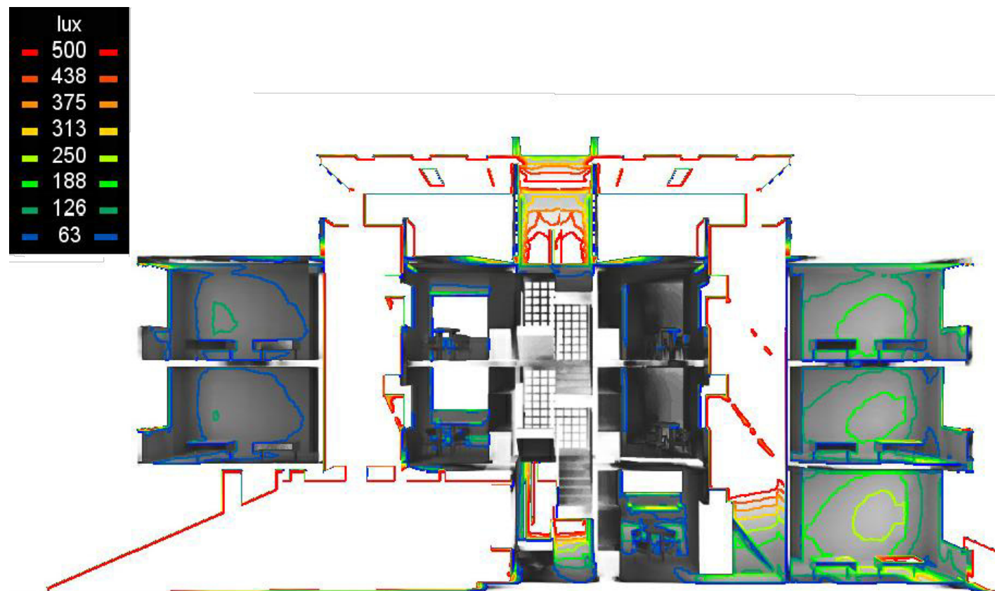
Análisis de ILUMINANCIA realizado con el software “VELUX Daylight Visualizer 3” con fecha 21 de Octubre a las 16:00 en el corte A -A
