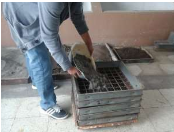
Ensayo granulométrico de las muestras de suelo
