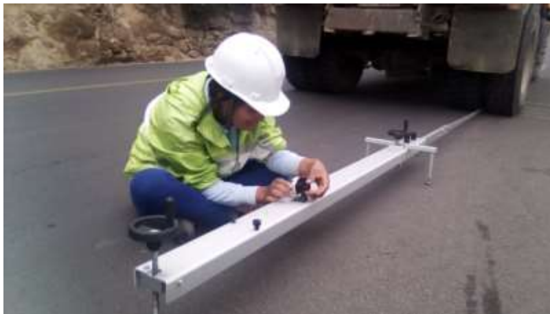
Figura 19: Viga usada en el ensayo
