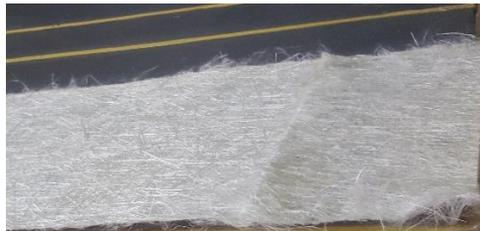
**Figura 3.9.** Fibra de vidrio siendo colocada en el molde
