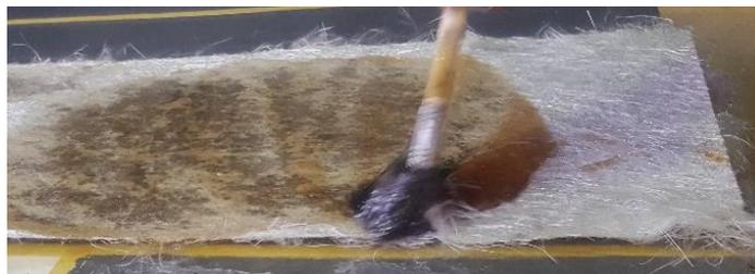
**Figura 3.10.** Resina y retardante de llama colocado en la fibra de vidrio
