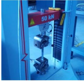
**Figura 3.17.** Colocación de las probetas de tracción en la máquina Metrotec MTE 50
