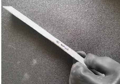
**Figura 3.14.** Probetas siendo lijadas
