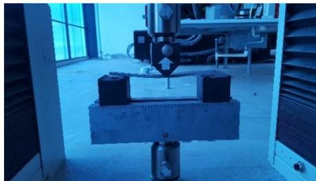
**Figura 3.20.** Probeta ensaya por el método A del ensayo de flexión según la Norma ASTM D7264
