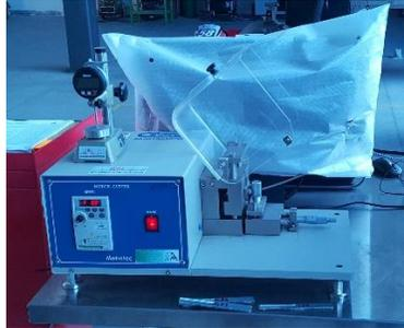
**Figura 3.21.** Máquina para realizar la muesca
