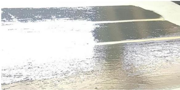
**Figura 3.6.** Aplicación de Gelcoat en el molde
