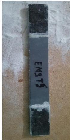
**Figura 3.15.** Pedazos de lija colocados en la probeta EM9-T5
