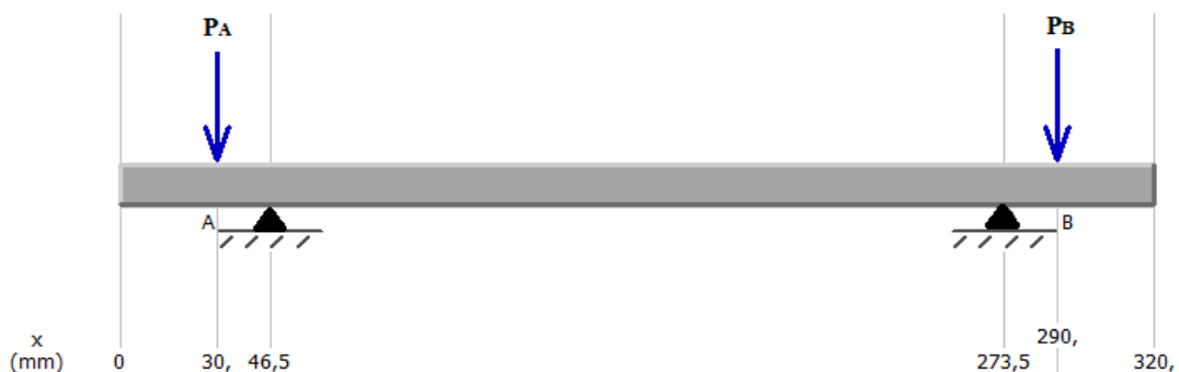
Figura 3.48. Diagrama del cuerpo libre del pasador
