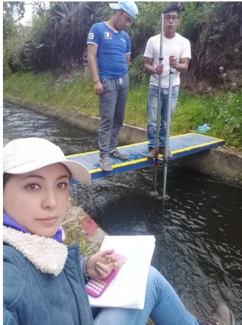
Tomando lectura de las velocidades puntuales – Sección 2
