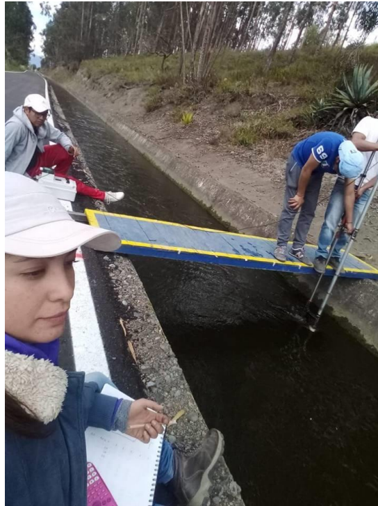
Tomando lectura de las velocidades puntuales – Sección 6
