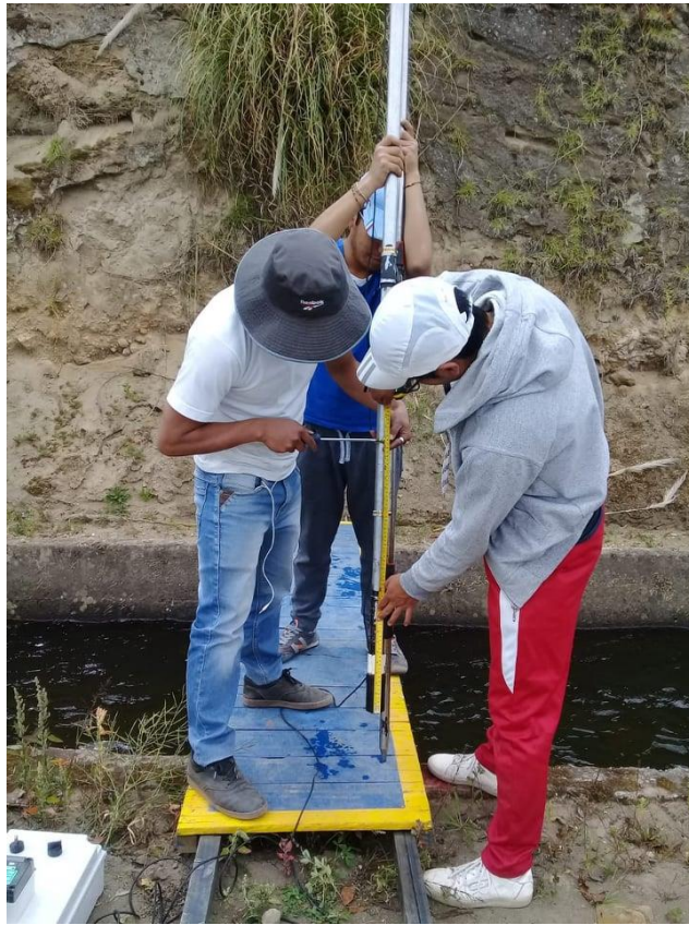
Colocando abrazaderas en las medidas a los 0.2, 0.6 y 0.8 de la profundidad del agua
