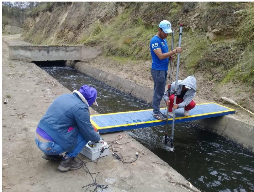
Tomando lectura de las velocidades puntuales – Sección 3
