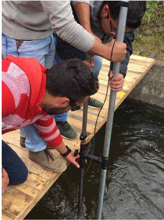
Prueba previa con el molinete
