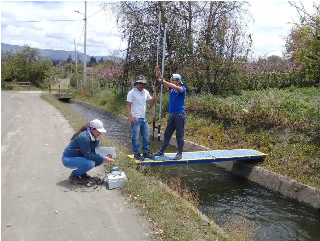
Figura 28. Medición de velocidades con el molinete
