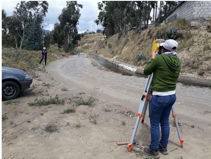
Figura 21. Topografía in situ del Canal
