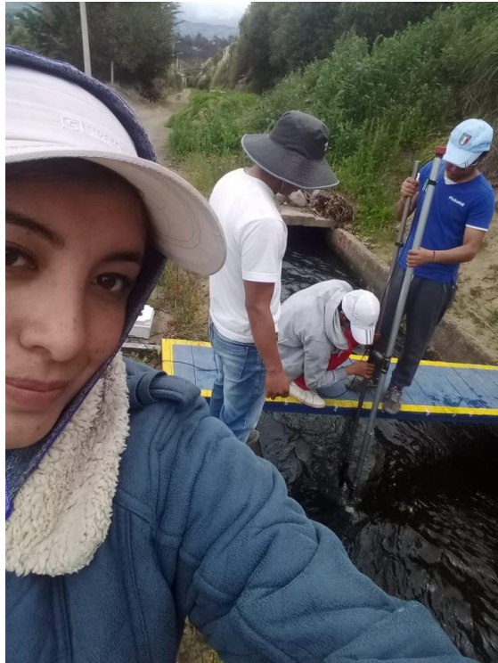
Tomando lectura de las velocidades puntuales – Sección 4
