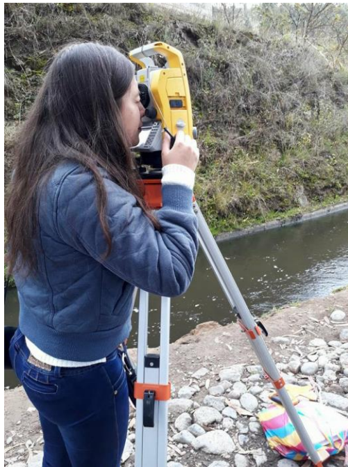
Visualizando el prisma para tomar la medida.
