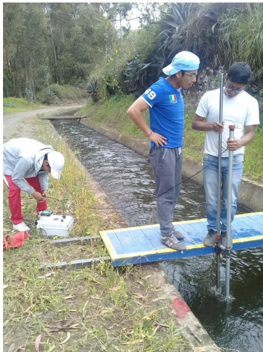
Tomando lectura de las velocidades puntuales – Sección 5
