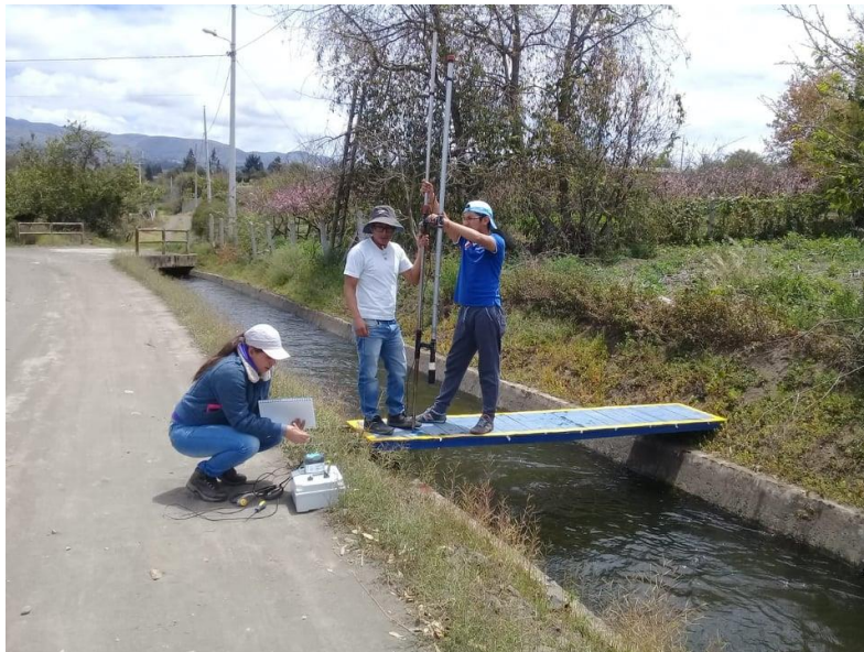
Tomando lectura de las velocidades puntuales – Sección 1
