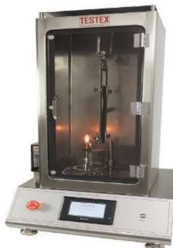
Figura 2. 16. Cámara de combustión vertical [24]
