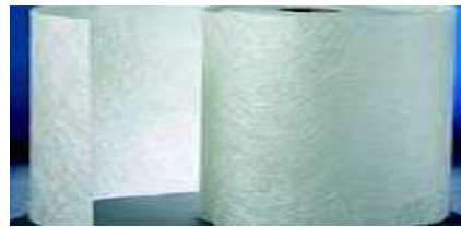
Figura 2. 8. Mat de hilos cortados [16].
