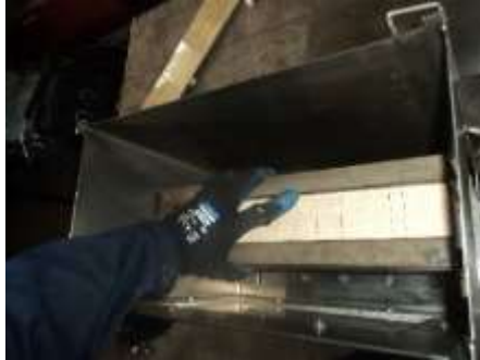
Figura 3. 5. Ubicación de la probeta en la cámara de combustión [Autor].
