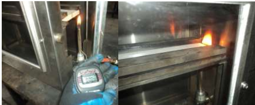
Figura 2. 199. Toma de tiempo para cortar el flujo del gas [Autor].
