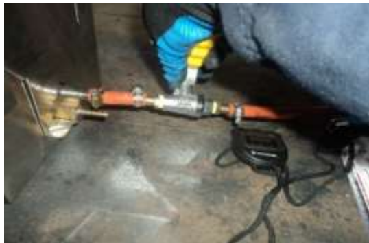
Figura 3. 7. Corte del flujo de gas. [Autor].
