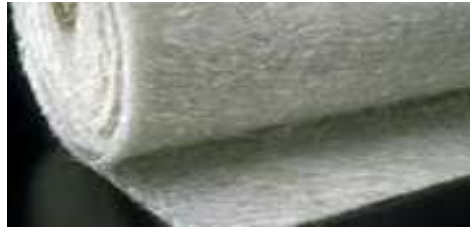
Figura 2. 7. Mat de filamento continuo [16].
