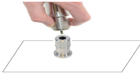
Fig. 6 Esquema de la colocación del actuador en la sufridera en la placa testigo
