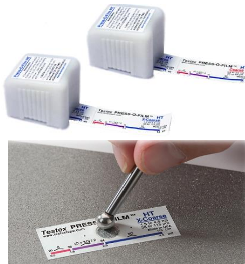
Fig. 1 Cinta réplica para medición del perfil de anclaje
