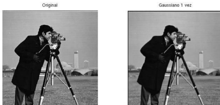
Figura 9 Izquierda: Imagen Original. Derecha: Imagen con Filtro Gaussiano Elaborado por: http://www.inf.ufrgs.br/~cwaraujo/inf01046/laboratorio1.html
