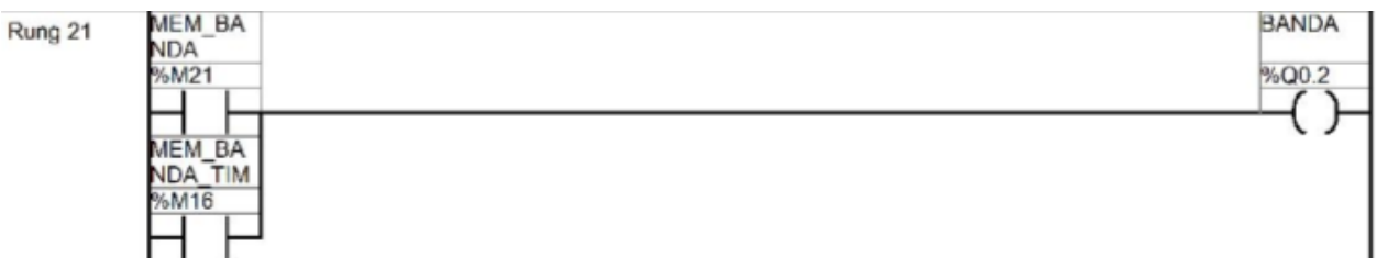
Gráfico 6-13 diagrama Ladder para estudio, salidas
