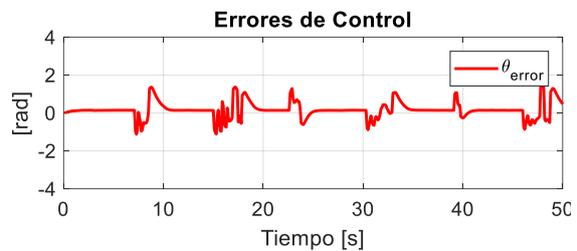
b) Error de rotación en la trayectoria ejecutada evitando obstáculos
