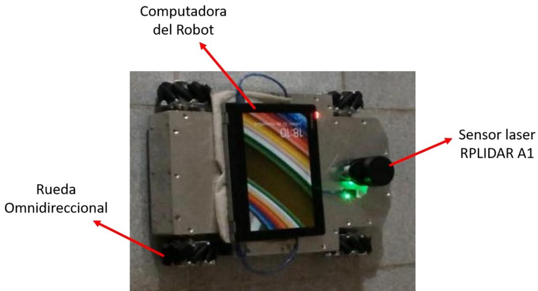
**Fig. 6.59** Robot omnidireccional con sensor laser.
