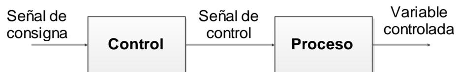
**Fig. 2.5** Control en lazo abierto
