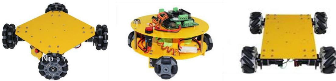
**Fig. 4.16** Tipos de robots Omnidireccionales.
