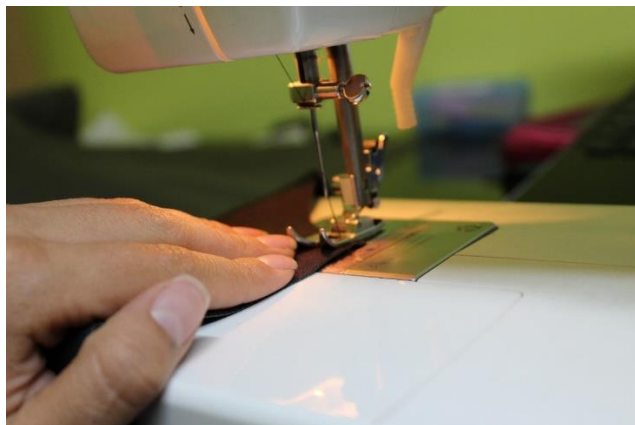
Imagen 46: Unión o ensamble de patrones
