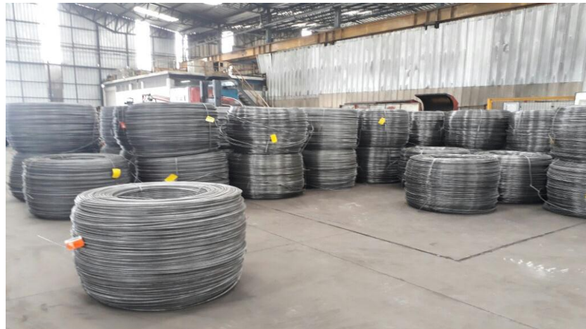
Gráfico 21. Materia prima “alambrón”, para el proceso de mallas y trefilados. Elaborado: Diego Javier Carrillo Abril
