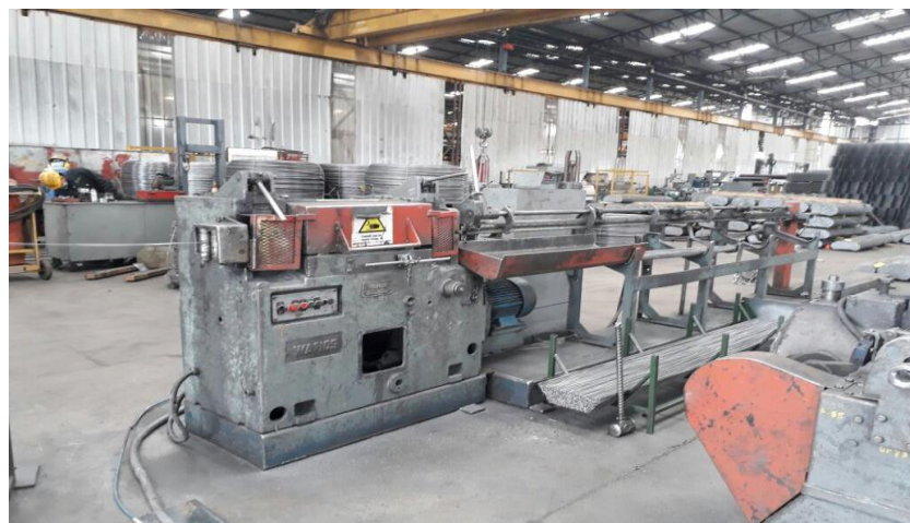
Gráfico 22. Máquina devanadora de alambón. Elaborado: Diego Javier Carrillo Abril
