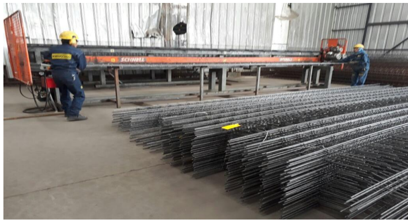
Gráfico 24. Máquina para la fabricación de vigas electrosoldadas. Elaborado: Diego Javier Carrillo Abril
