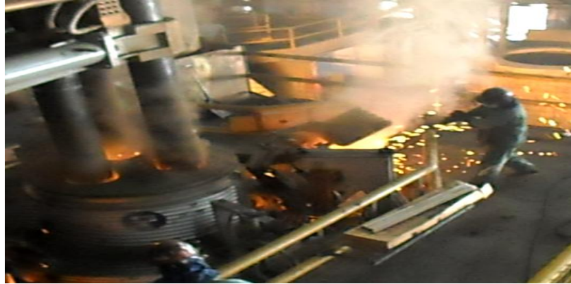
Gráfico 15. Proceso de afino del acero en el horno cuchara, LF. Elaborado: Diego Javier Carrillo Abril
