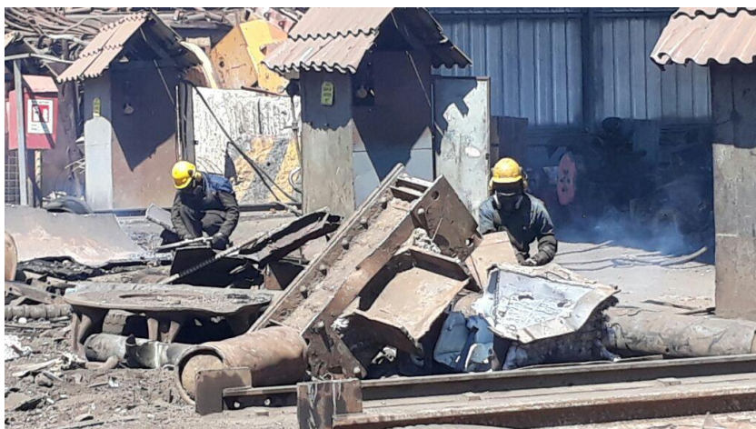
Gráfico 10. Proceso de corte manual de chatarra. Elaborado: Diego Javier Carrillo Abril
