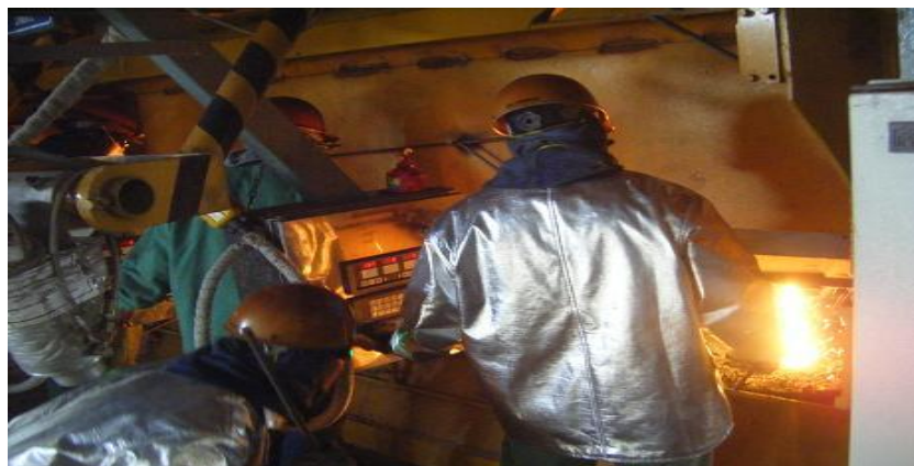
Gráfico 16. Proceso de colado del acero líquido. Elaborado: Diego Javier Carrillo Abril
