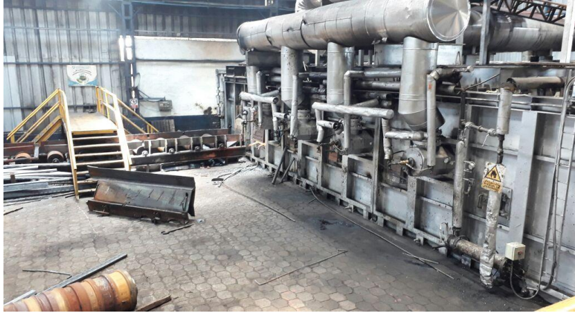
Gráfico 18. Horno de precalentamiento del Tren 1. Elaborado: Diego Javier Carrillo Abril
