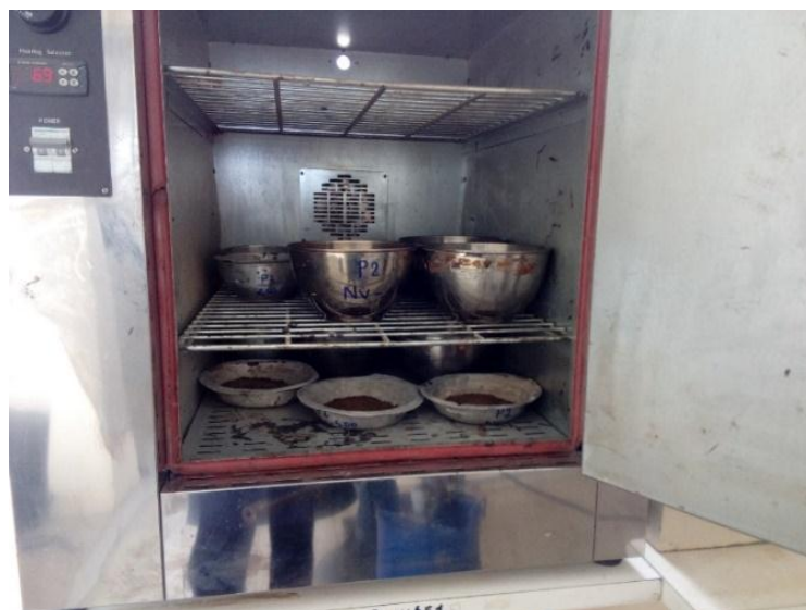
Fotografía 6. Muestras de suelo colocadas en el horno
