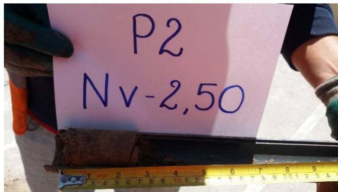
Fotografía 2. Suelo retenido en el muestreador
