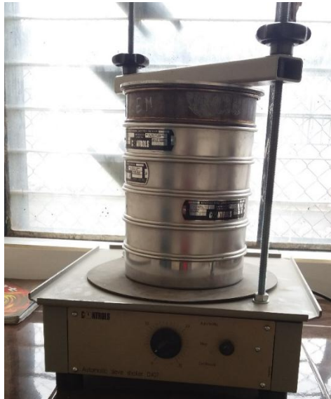
Fotografía 4. Ensayo granulométrico empleando la tamizadora eléctrica
