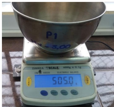
Fotografía 5. Pesando la muestra del Pozo 1; Nv. -3,00 m
