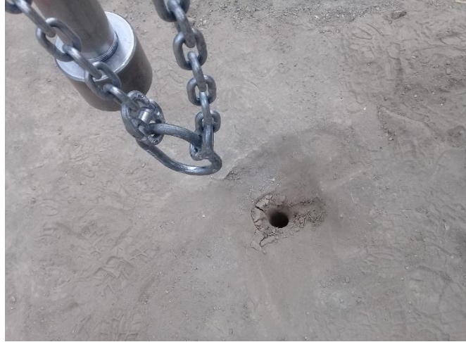
Fotografía 3. Perforación realizada por el equipo SPT
