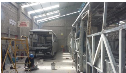
Figura N° 2.1 Proceso de armado de estructura.
