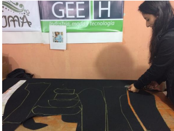
Fig. 31 Proceso de tizado en la empresa GEETH. Elaborado por: Investigador basado en [4]
