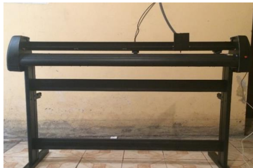
Fig. 80 Sistema de impresión de patrones de prendas de vestir. Elaborado por: Investigador
