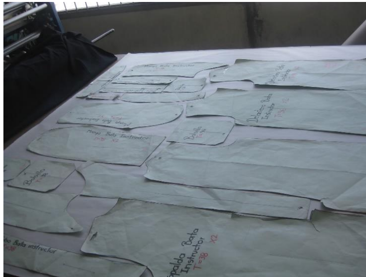
Fig. 7 Colocación de los moldes para el tizado manual. [16]
