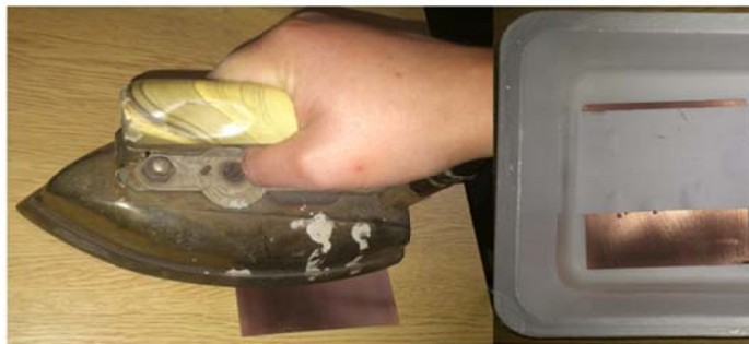
Figura 2. Traslado de las pistas a la baquelita
