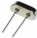
Figura 6.8 Cristal de oscilación de 4Mhz
