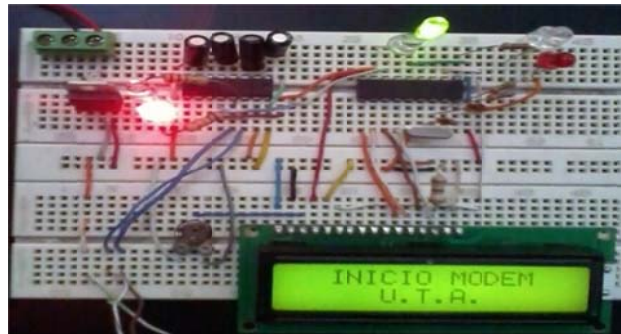
Figura 6.47 Implementación en protoboard de las placas transmisora y receptora
