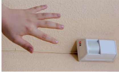
Figura 6.21 Sensor de presencia
