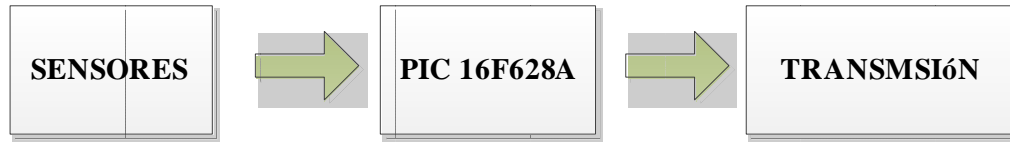
Figura 4.15 Diagrama de bloques de la placa transmisora
