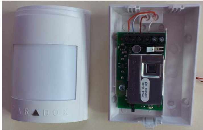
Figura 6.30 Vista interna del sensor de presencia PARADOX
